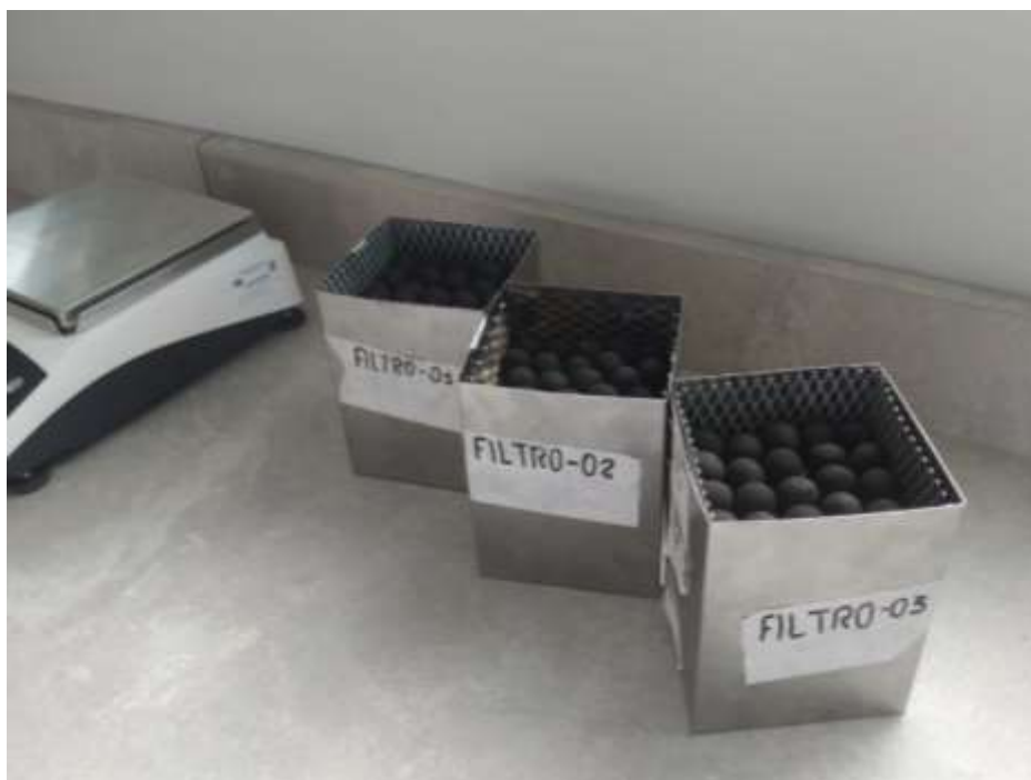
Nota: Filtros de carbón activado
