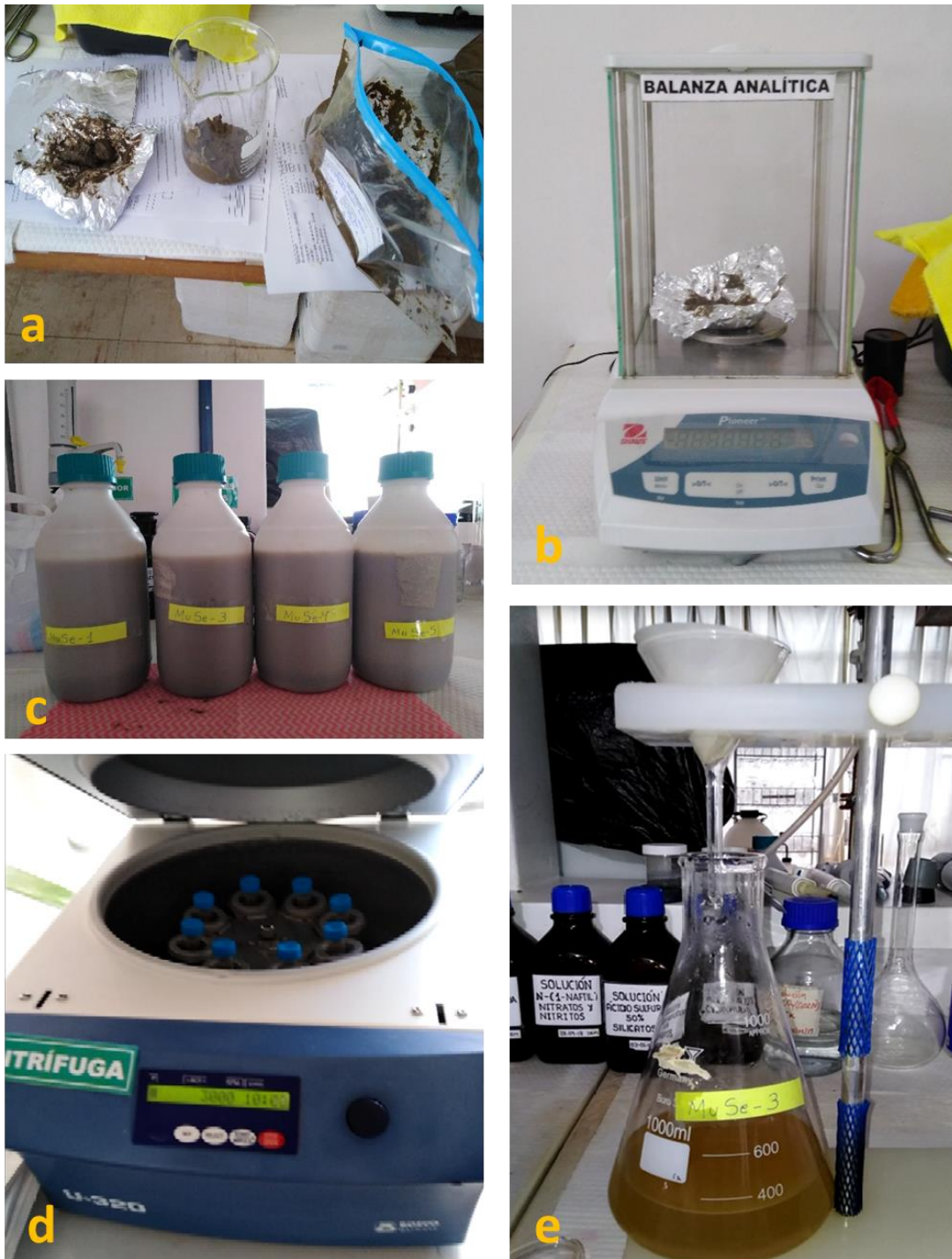
Figura 6. a. y b. Pesado de muestras de sedimentos. c. Mezcla de sedimentos y agua de lago filtrado. d. Centrifugación de los compuestos. e. Filtrado del elutrado. Fuente: Elaboración propia.
