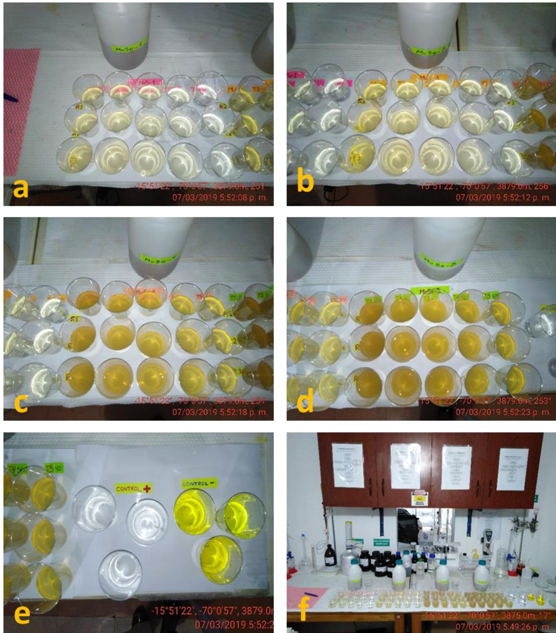
Figura 13. a. Bioensayos de la MuSe-01; b. Bioensayos de la MuSe-03; c. Bioensayos de la MuSe-04; d. Bioensayos de la MuSe-05; e. Pruebas de control positivo y negativo; f. Pruebas definitivas.
