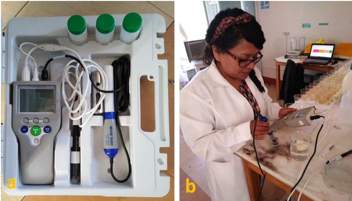
Figura 11. a. Multiparámetro Metler Toledo; b. Medición de parámetros de pH, T°, OD de todas las diluciones.
