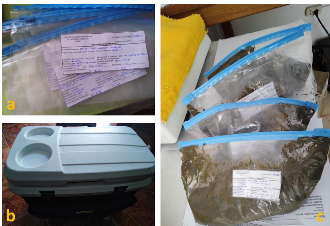
Figura 5. a. Envases etiquetados y rotulados; b. Muestras transportadas en cooler; c. Muestras de sedimentos.
