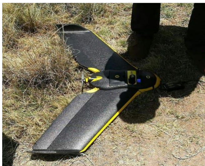
Figura 3. Equipo dron Eevee para la realización de fotogrametría.
