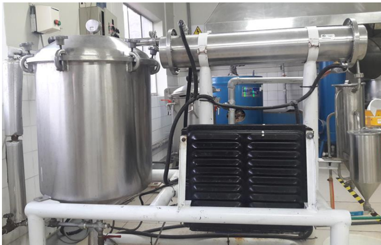
Figura 10. Esquema de arrastre de vapor de extracción de aceite esencial de menta negra (AEMN).
