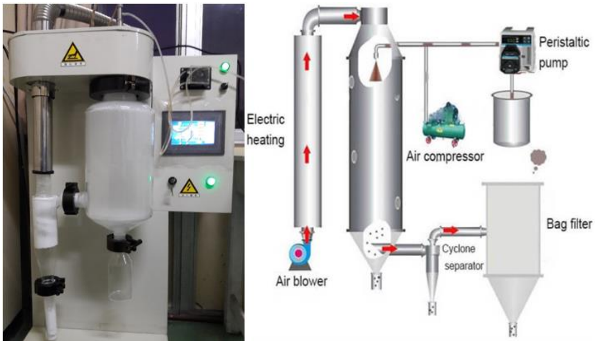
Figura 9. Esquema de proceso de atomización de Spray Dryer (TP-S15, TOPTION)
