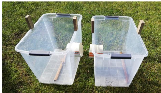
Fig. 2. Sistema de cámaras anódicas y catódicas de CCM-P
