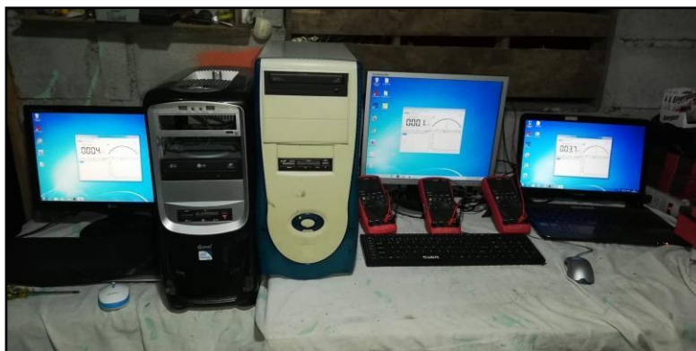
Fig. 4. Instalación de equipos de medición y lectura de datos
