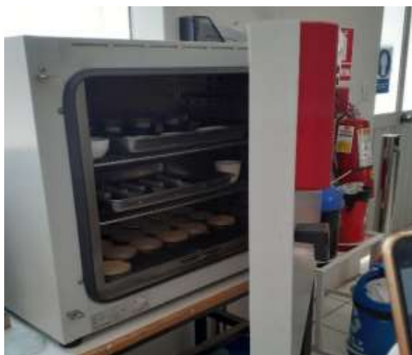
Anexo 6.7. Desechado de biomazas Tarwi y Haba a una temperatura de 105 °C en un tiempo de 40 minutos.
