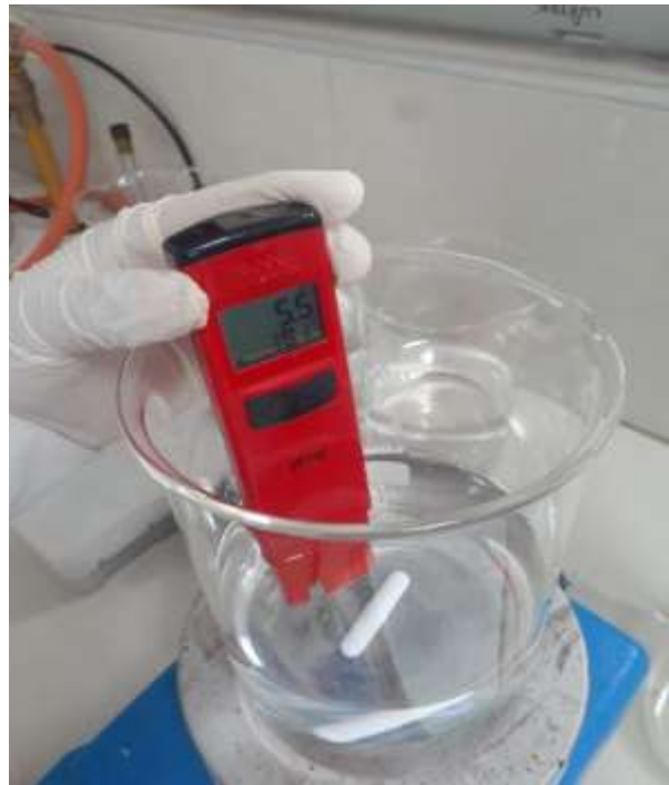
Anexo 6.9. Regulando el pH a la muestra de agua a pH de 5.5 (Haba) y 5.2 (Tarwi).
