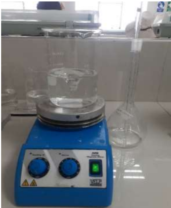
Anexo 6.9. Regulando el pH a la muestra de agua a pH de 5.5 (Haba) y 5.2 (Tarwi).
