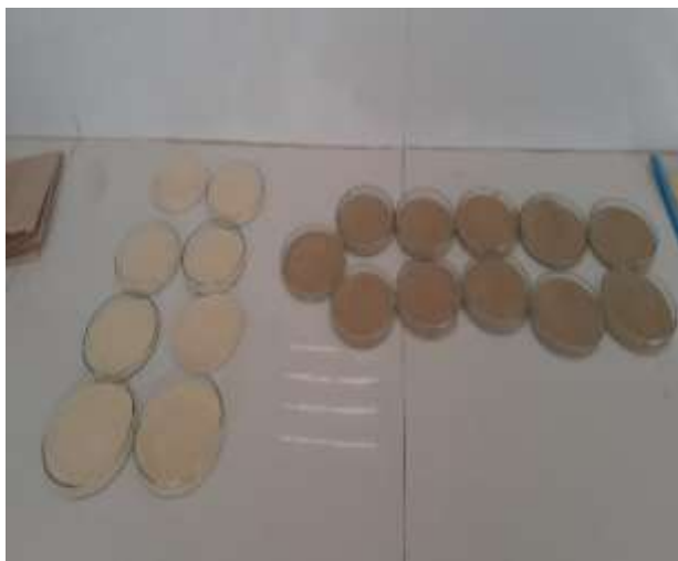
Anexo 6.7. Desechado de biomazas Tarwi y Haba a una temperatura de 105 °C en un tiempo de 40 minutos.
