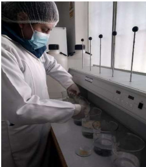
Anexo 6.10. Aplicación de la biomasa para realizar la prueba de Jarras. Derecha Tarwi – Izquierdo Haba.
