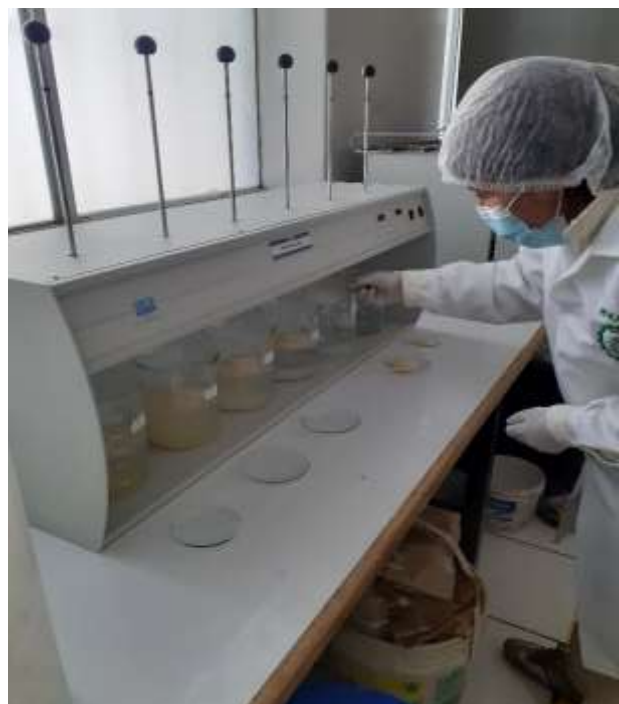
Anexo 6.10. Aplicación de la biomasa para realizar la prueba de Jarras. Derecha Tarwi – Izquierdo Haba.
