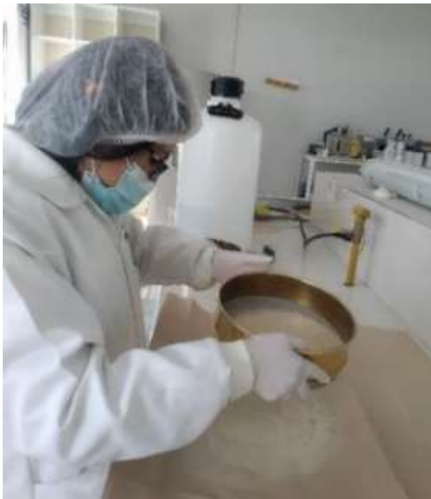
Anexo 6.6. Tamizado de biomásas. Derecha cáscara de Haba – izquierda cáscara de Tarwi.
