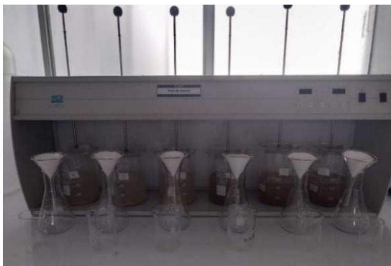
Anexo 6.12. Sedimentación durante 30 min. Después de la remoción de Arsénico.
