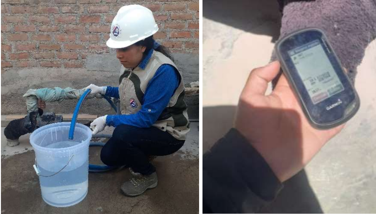
Anexo 6.1. Toma de muestra de agua subterránea y obtención de coordenadas con GPS del punto de muestreo.
