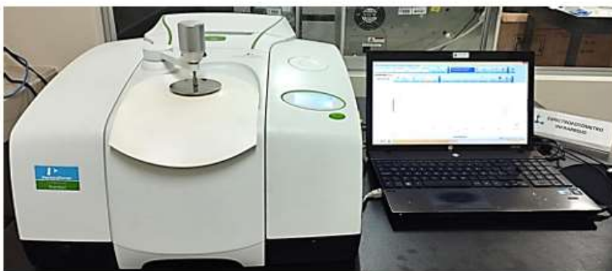
FIGURA N°2. Espectrofotómetro Infrarrojo de Transformadas de Fourier - Reflectancia total atenuada (FTIR-ATR). PERKIN ELMER, FRONTIER.
