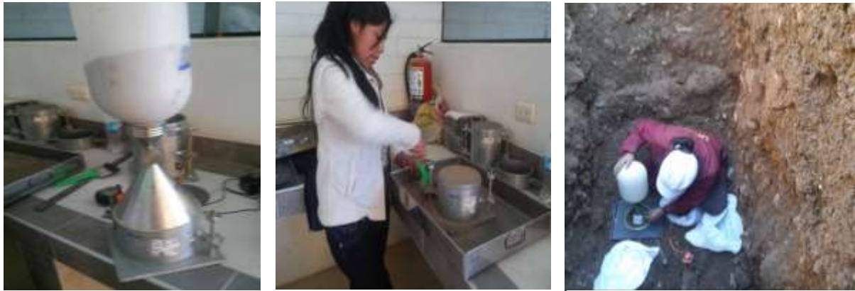
(a) y (b) Determinación de la densidad de la arena en laboratorio
