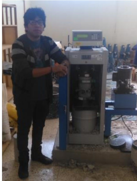
Figura 20. Prensa hidráulica de concreto.
