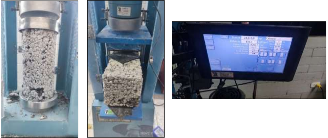
Figura 3: Ensayo de resistencia a la compresión y a la flexión
