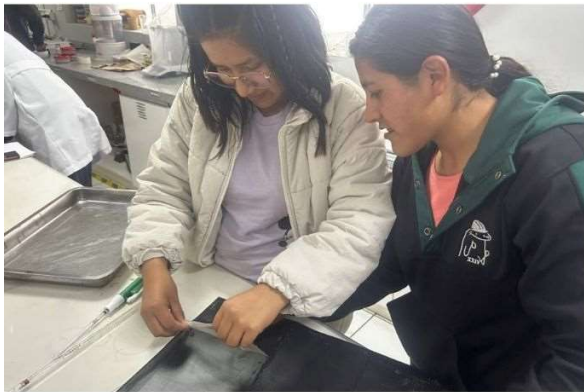
Desmoldar el BP
