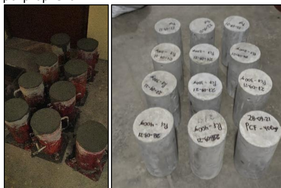
Fig. 4. Especímenes de Concreto con f'c=210 kg/cm 2 en Estado Fresco y Endurecido. a) Especímenes de Concreto en Estado Fresco. b) Especímenes de Concreto en Estado Endurecido.
