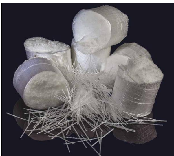
Fig. 1. Presentación de la fibra laminada de Polipropileno de Sika Fiber PE. [10]
