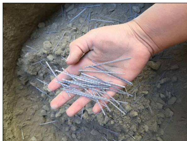
Fig. 3. Fibra de Polipropileno añadida a la Mezcla de Concreto Simple con f'c=210 kg/cm 2 .
