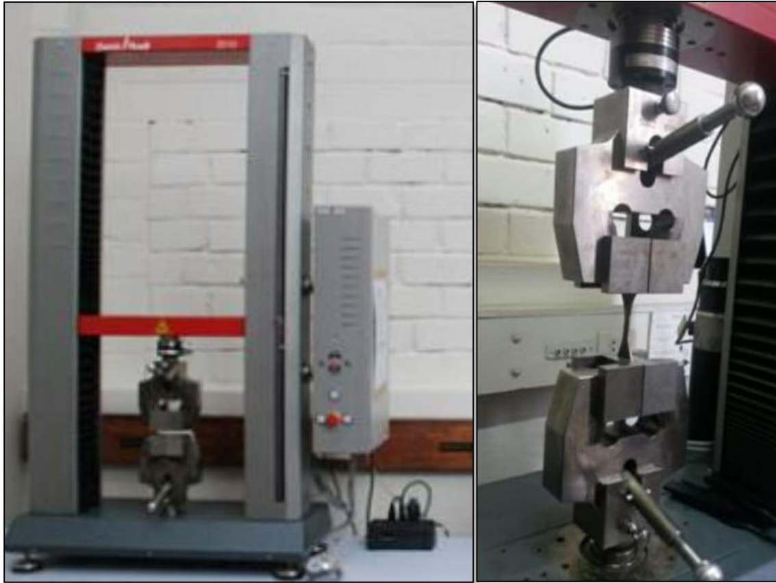
Figura 7. Máquina de tracción universal. ZWICK ROELL, Z010 Y Vernier digital. MITUTOYO CORPORATION, CD-6” BS.
