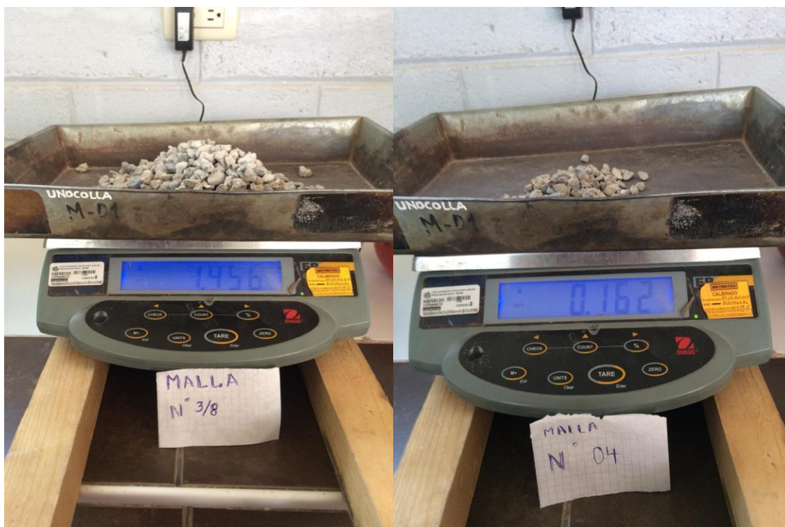
Fotografía 15. Peso de las mallas retenidas
