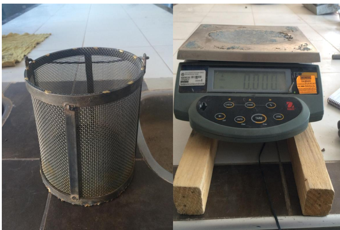
Fotografía 28. Canastilla y Balanza. Ensayo peso específico y absorción.
