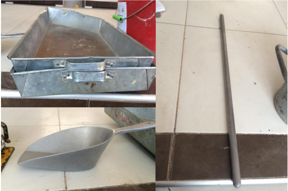
Fotográfica 24. Equipos para el ensayo de peso unitario (bandejas, cucharon y varilla).
