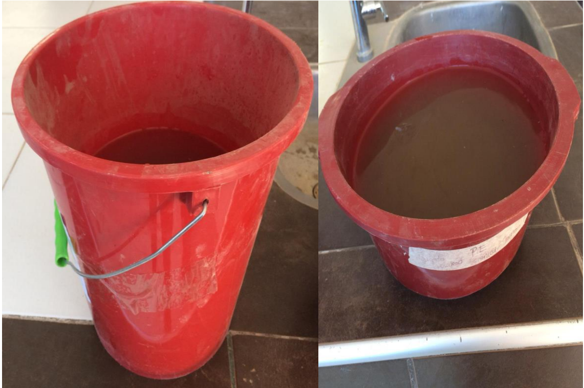
Fotografía 29. Sumergido de los agregados grueso y fino durante 24 horas. Para el ensayo de peso específico y absorción
