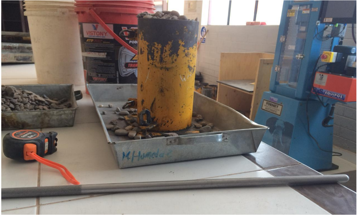
Fotografía 26. Ensayo del peso unitario compactado del agregado grueso.
