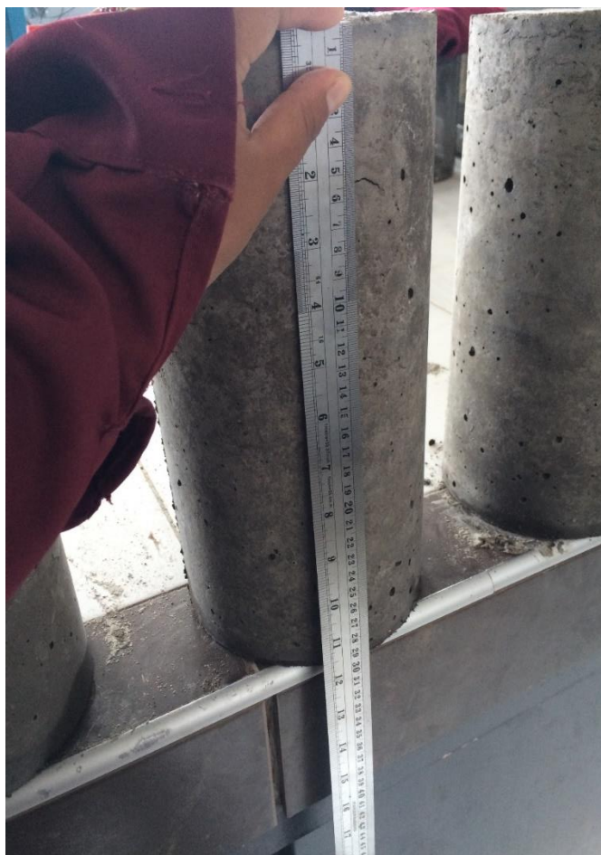
Fotografía 47. Medidas de las briquetas
