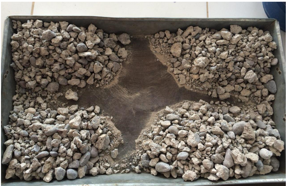
Fotografía 10. Cuarteo del material reciclado
