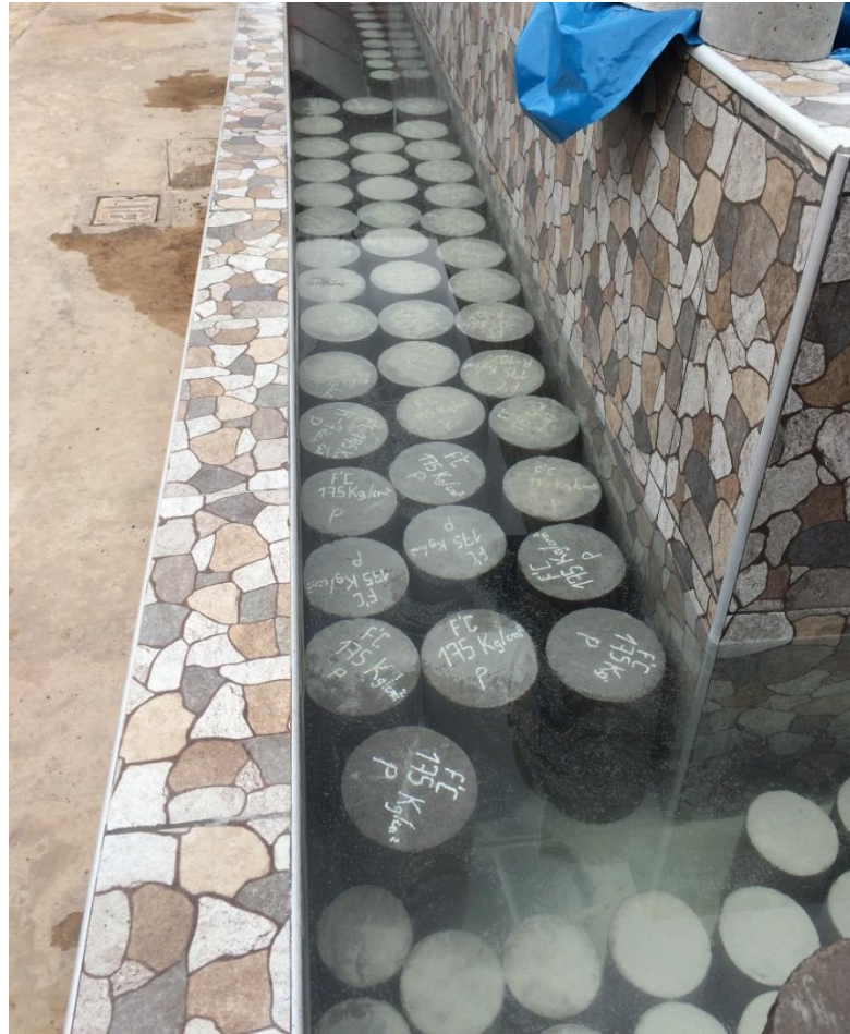
Fotografía 43. Curado de las briquetas en las pozas de agua, con su respectiva etiqueta
