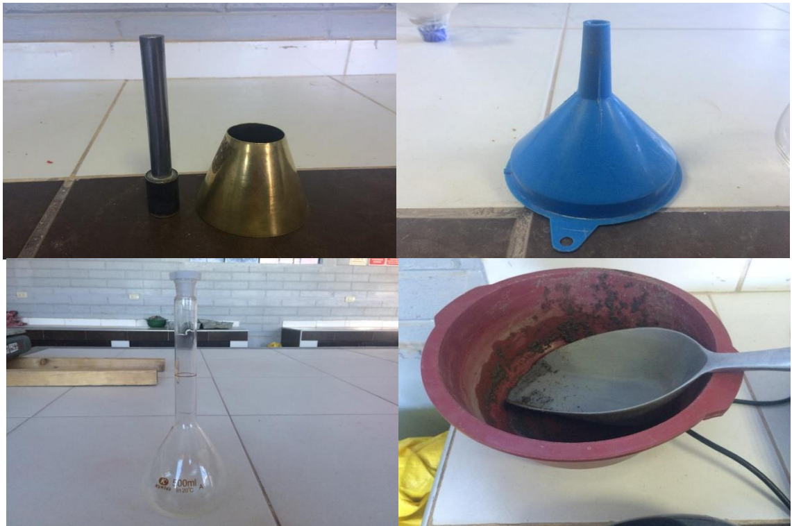
Fotografía 33. Equipos como cono, embudo, picnómetro, cucharon y bandeja
