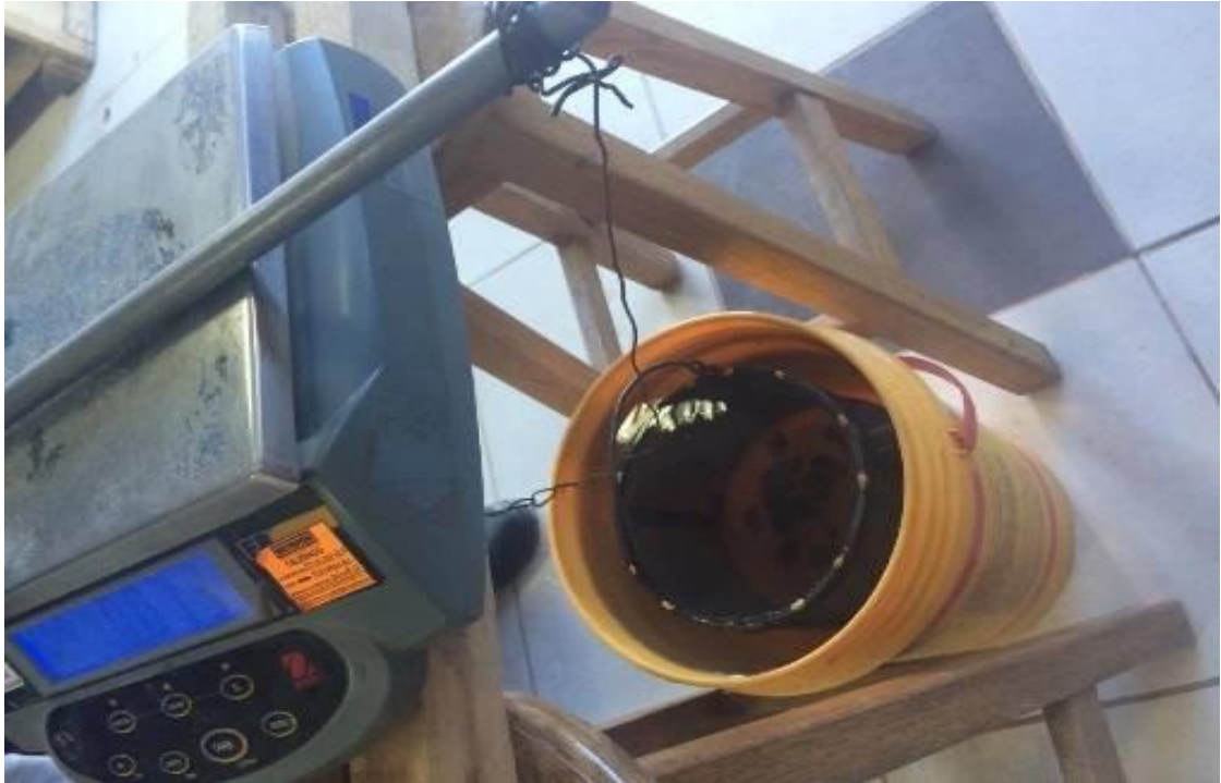
Fotografía 31. Peso del agregado grueso sumergido al agua junto a la canastilla. Absorción
