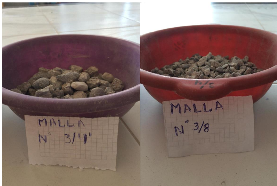
Fotografía 13. Muestra ya tamizada de las mallas 3/4" y 3/8"
