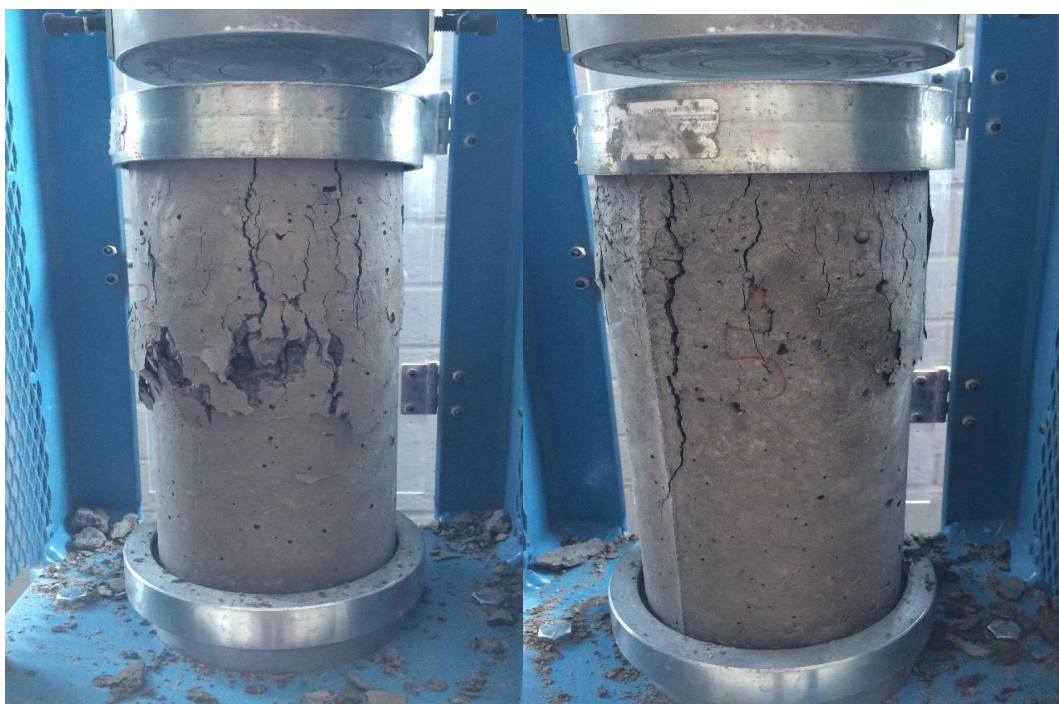
Fotografía 49. Rotura de briquetas a los 7 días
