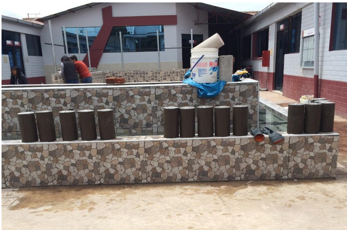
Fotografía 45. Briquetas sacadas de la poza para el ensayo de compresión a los 7 días
