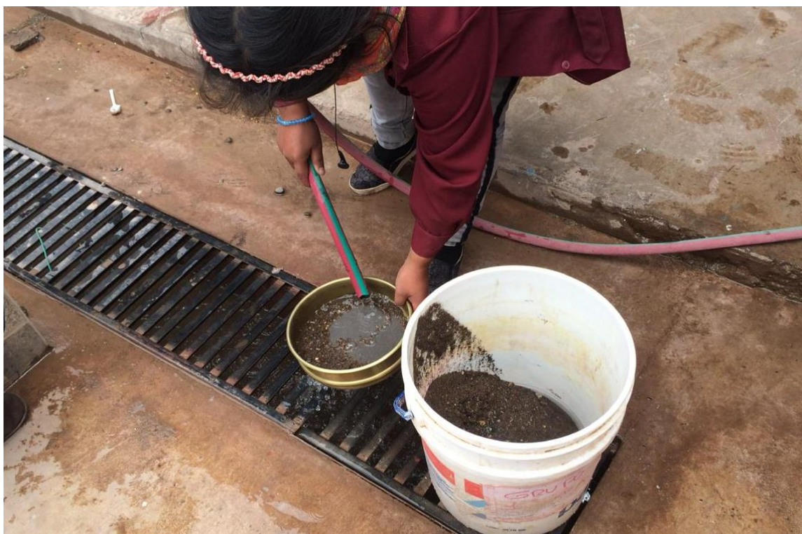
Fotografía 20. Lavado del agregado fino con la ayuda de la malla n°50
