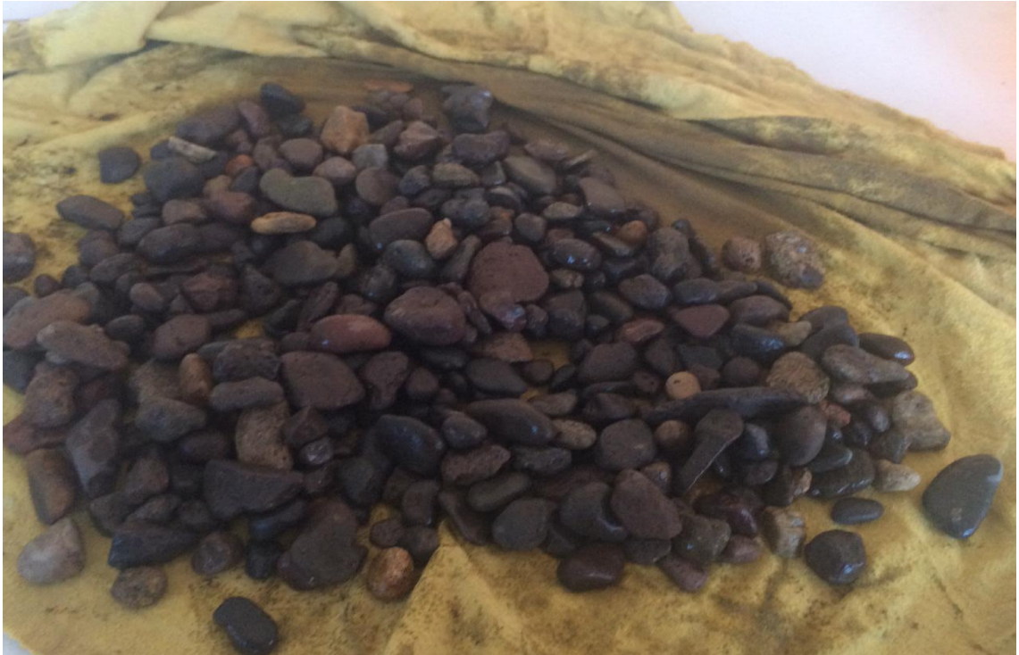
Fotografía 30. secado superficial del agregado grueso después de ser sumergido al agua durante 24 horas.
