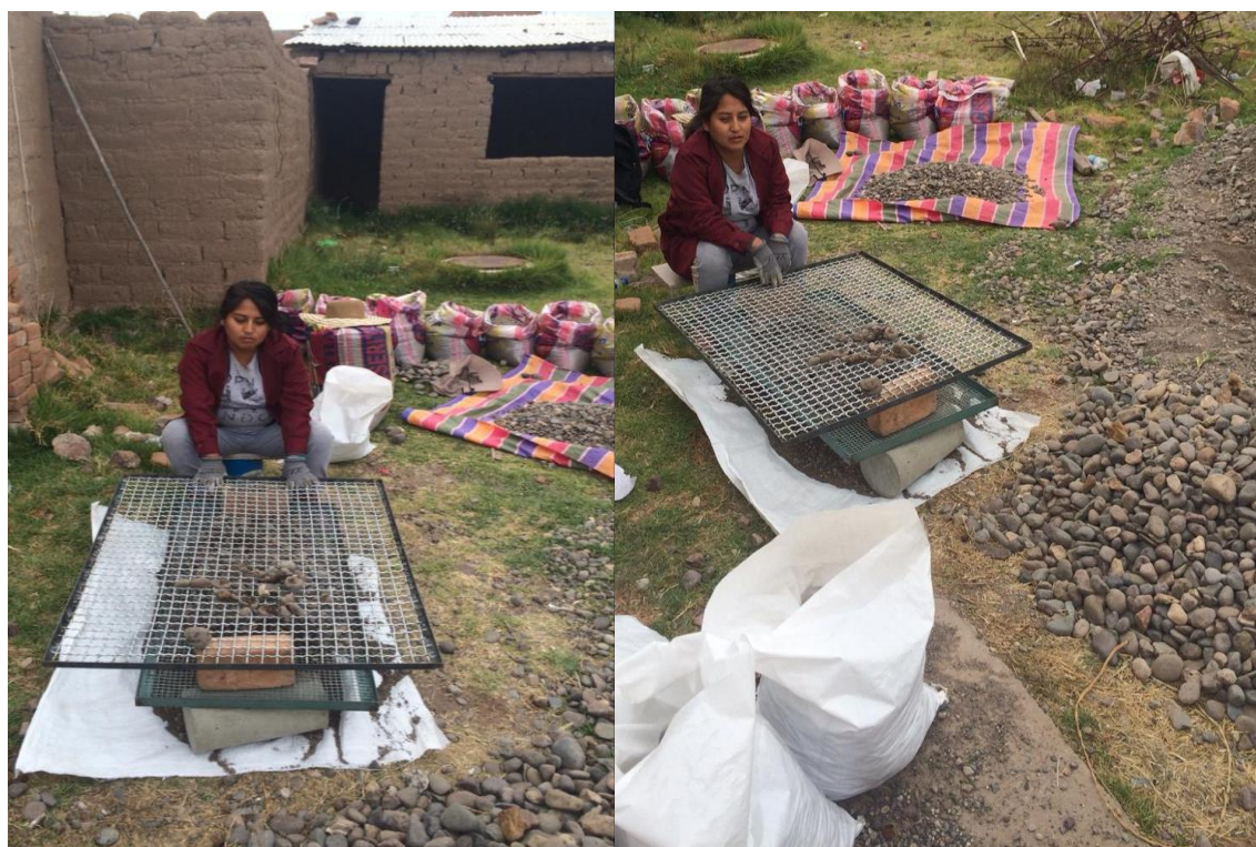
Fotografía 16. Eliminación del agregado grueso retenido en la malla de 1"
