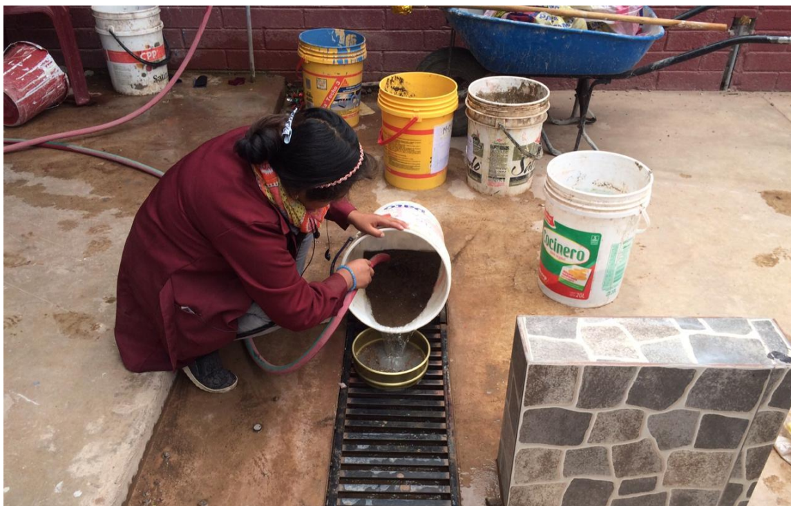
Fotografía 19. Lavado del agregado fino
