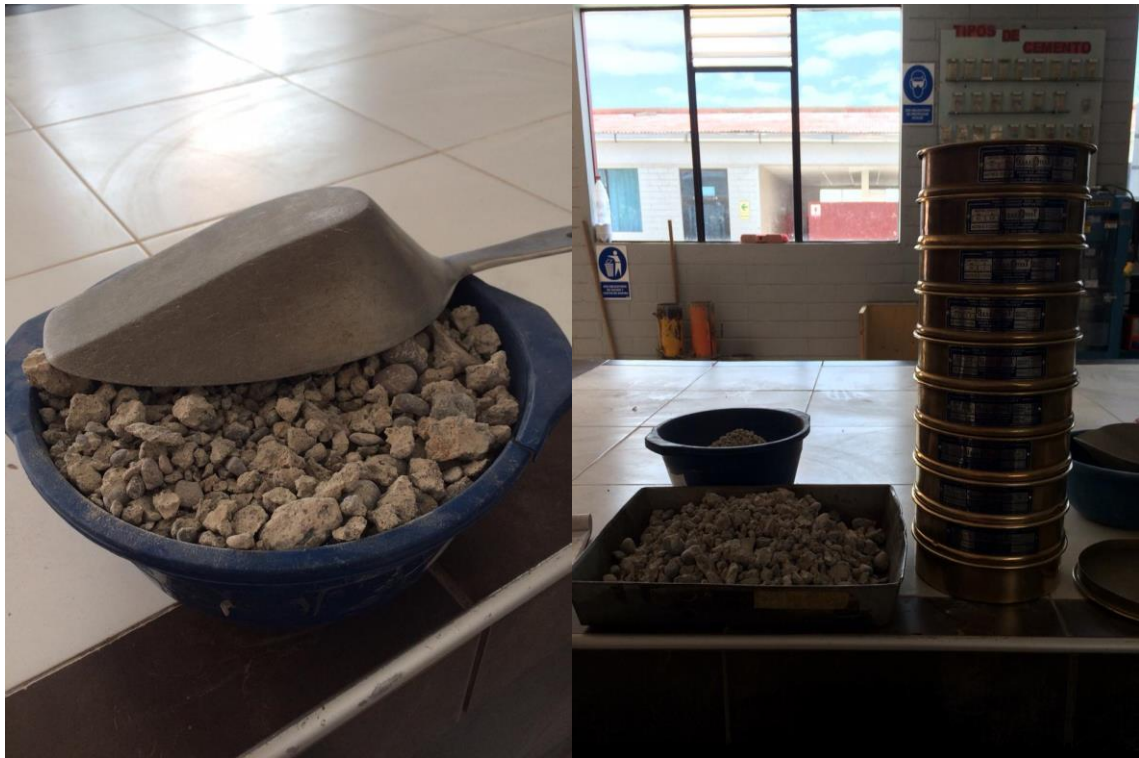
Fotografía 9. Muestra de agregado reciclado a utilizar para el ensayo de la granulometría
