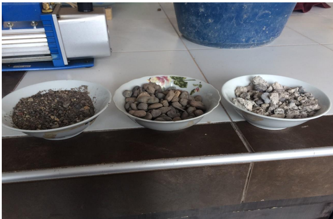
Fotografía 35. Muestra sacada del horno para determinar su contenido de humedad
