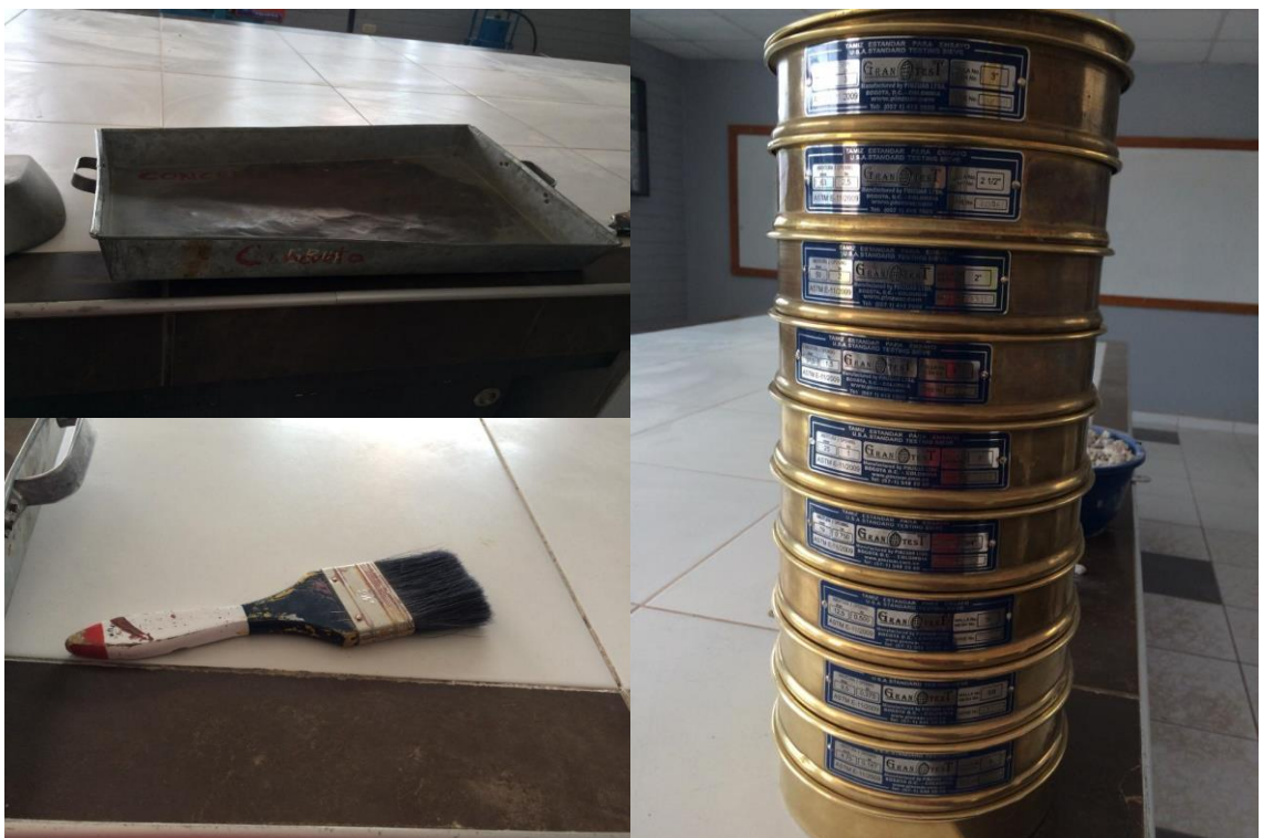
Fotografía 8. Bandeja, brocha y tamices utilizados
