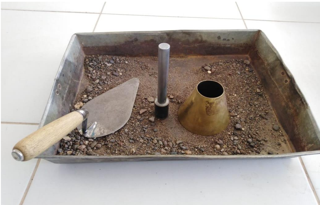
Fotografía 32. Equipos de badilejo y cono .ensayo para el agregado fino.
