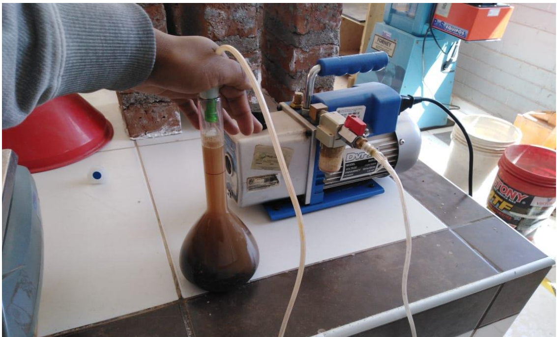
Fotografía 34. Ensayo de absorción del agregado fino, eliminación de aire atrapado del picnómetro
