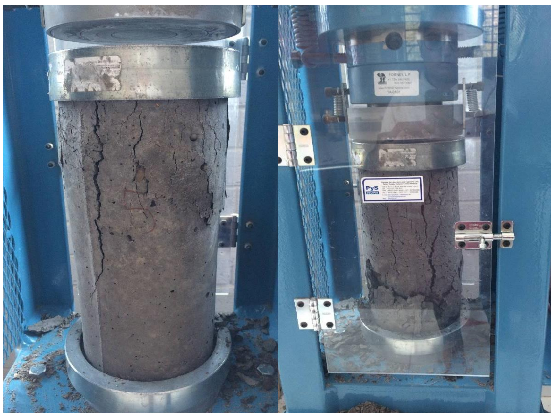
Fotografía 51. Rotura de briqueta
