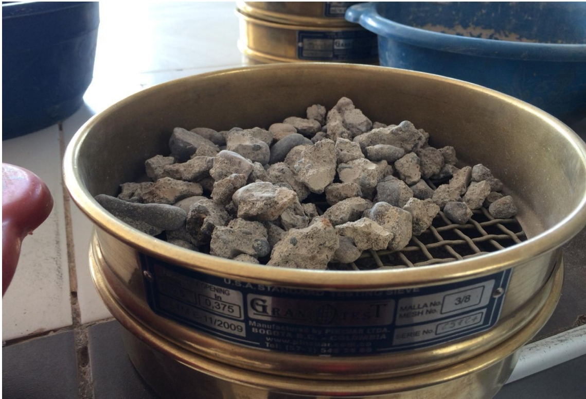
Fotografía 12. Material retenido en la malla n° 3/8"
