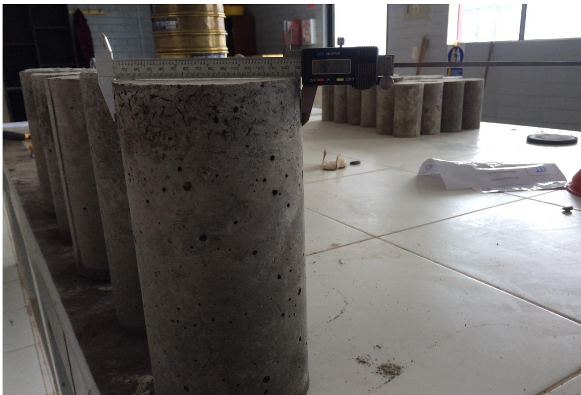
Fotografía 46. Midiendo su diámetro con el vernier
