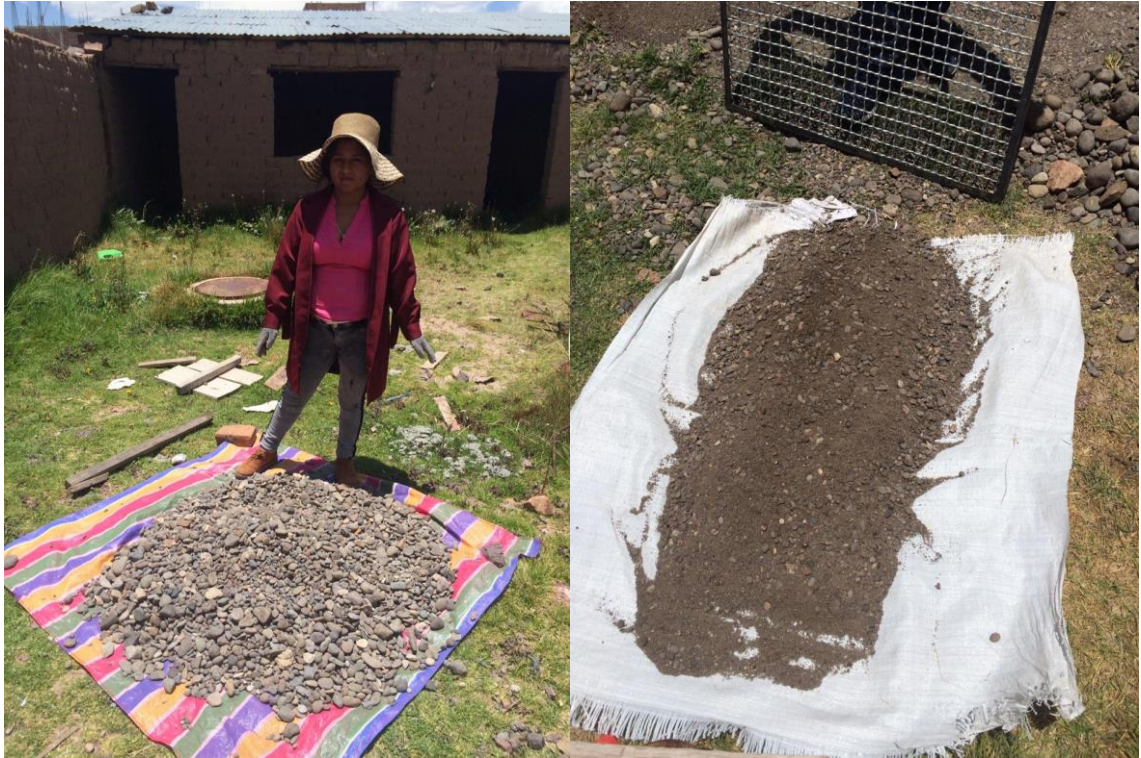
Fotografía 17. Separación del agregado grueso y fino con la malla 3/4"
