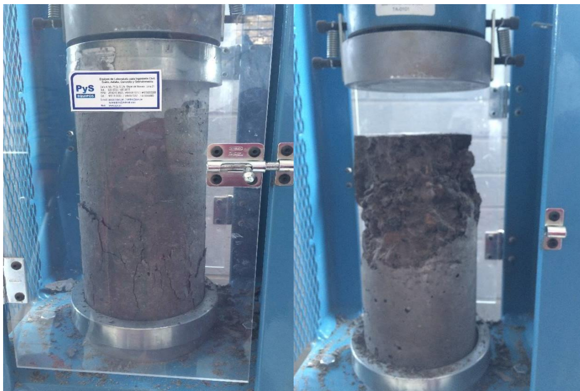
Fotografía 50. Rotura de briquetas
