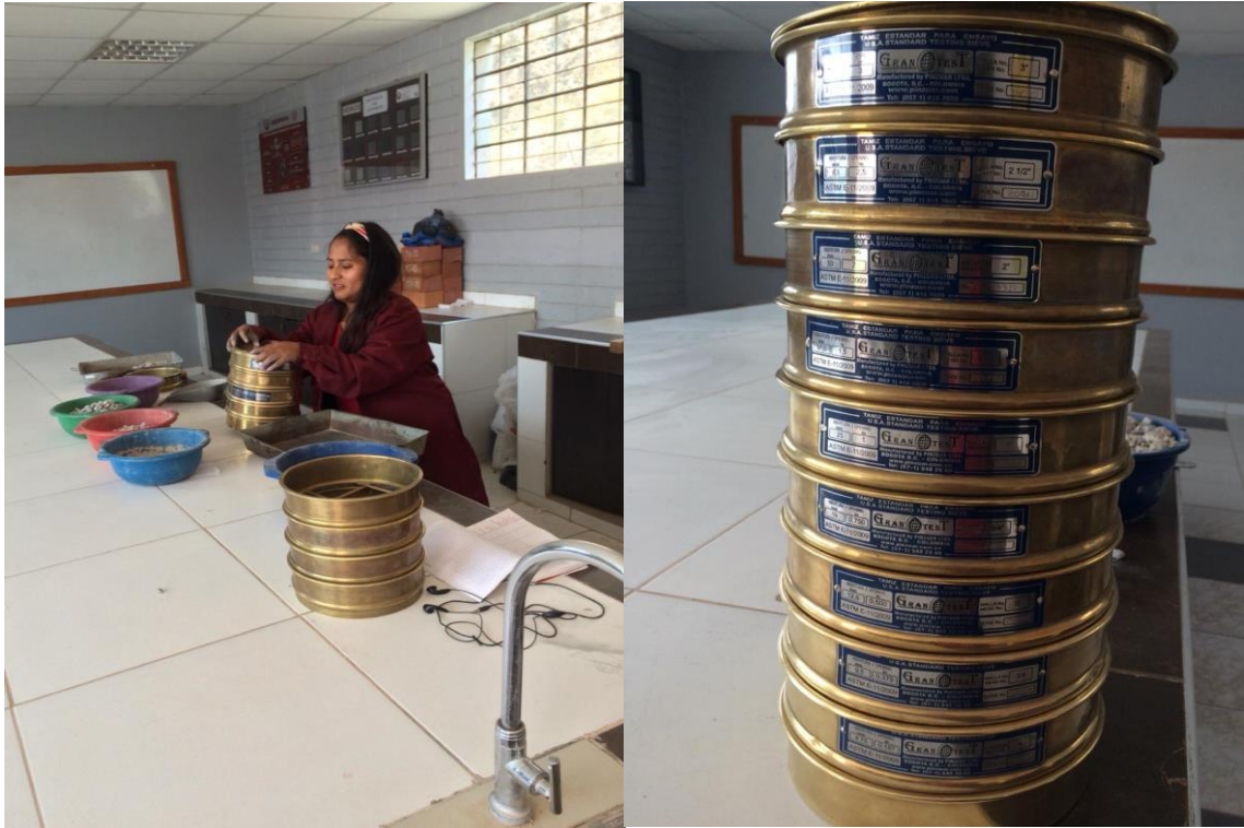
Fotografía 11. Ensayo de la granulometría para agregados reciclados.
