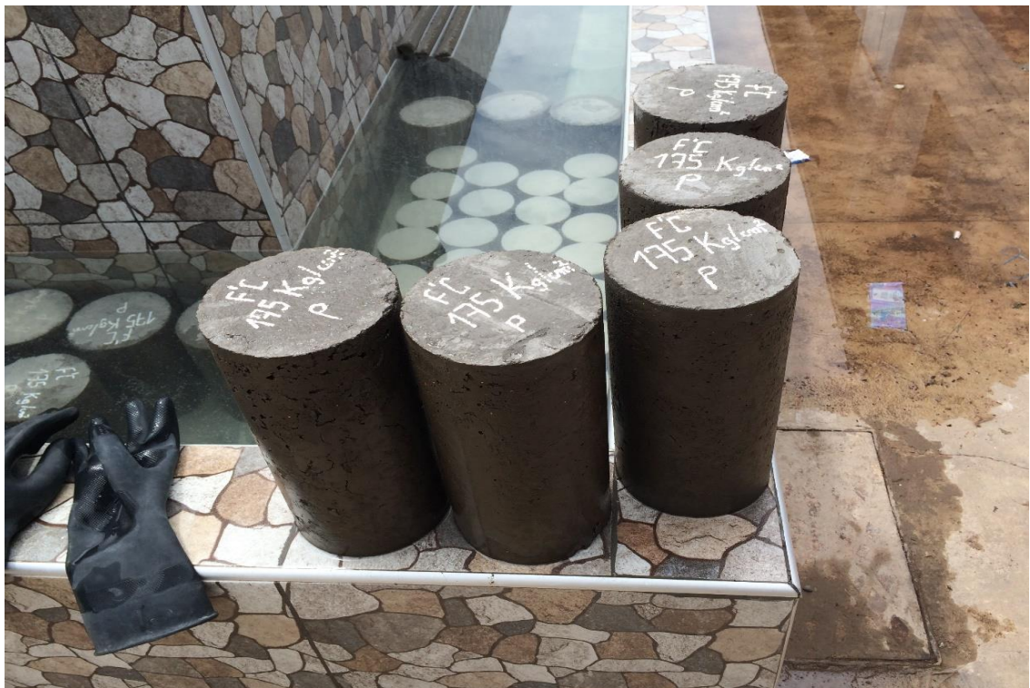
Fotografía 44. Sacado de briquetas para el ensayarlos a compresión
