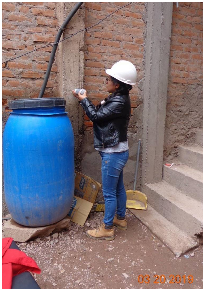
Fotografía 54. Ensayo de esclerómetro sometida a una columna antigua.
