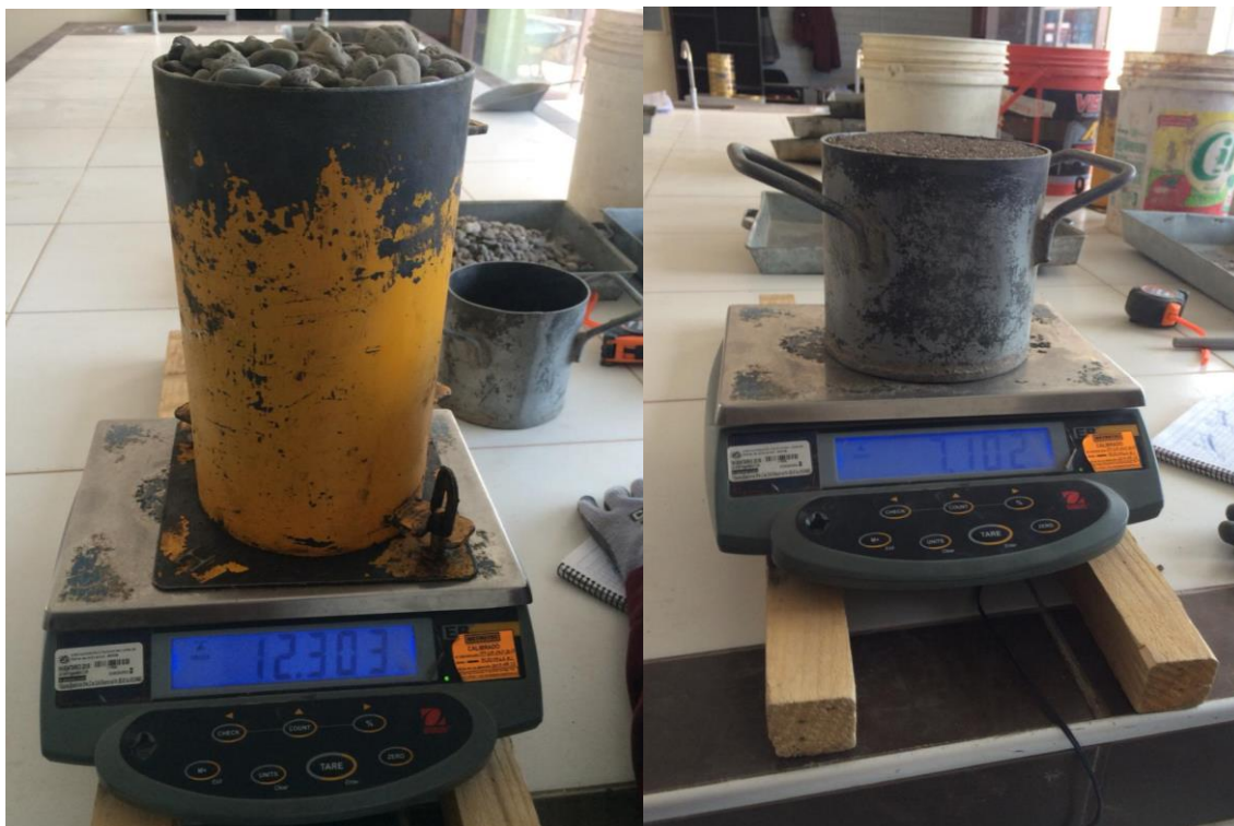
Fotografía 27. Pesando el agregado grueso y fino. Peso unitario compactado.
