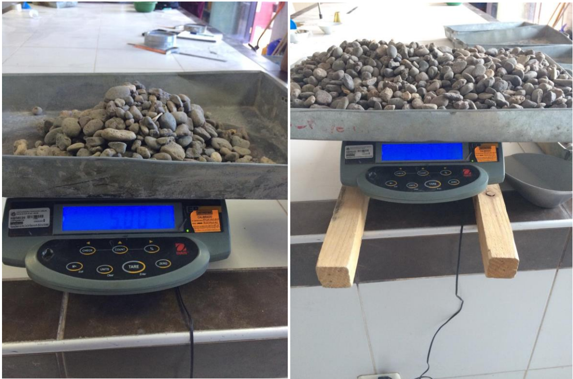
Fotografía 22. Peso retenido en las mallas.
