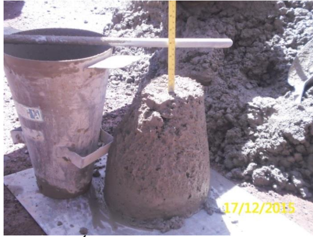
FOTOGRAFÍA N° 28. Haciendo la prueba del slump con el cono Abrams. Diciembre del 2015.
