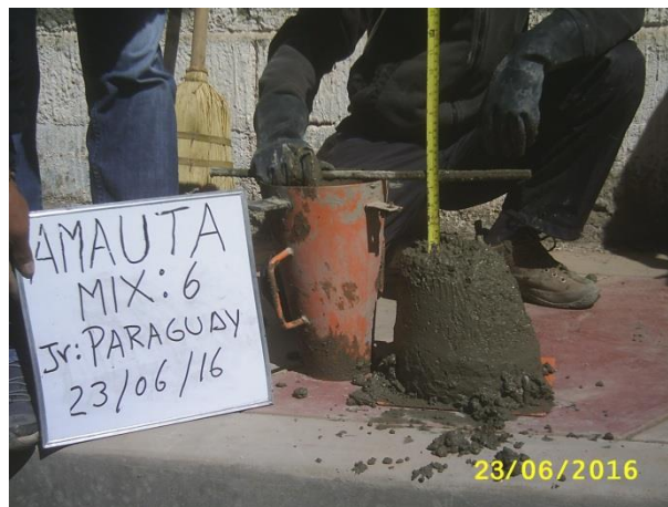
FOTOGRAFÍA N° 20. Haciendo la prueba del slump con el cono Abrams. Junio del 2016.
