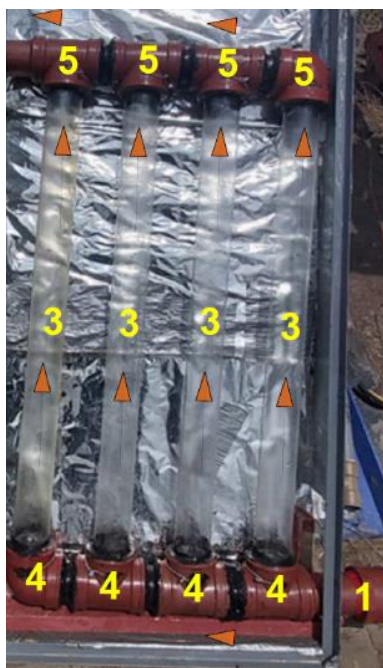
Figura 23. Vista de Planta del circuito de tubería de tipo Pyrex montado con tubería PVC de tipo IPS.
