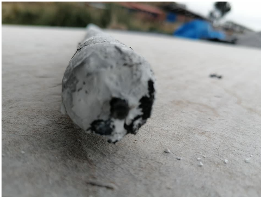
Figura 8. Varilla de madera Fijado con Dióxido de Titanio (TiO 2 )
