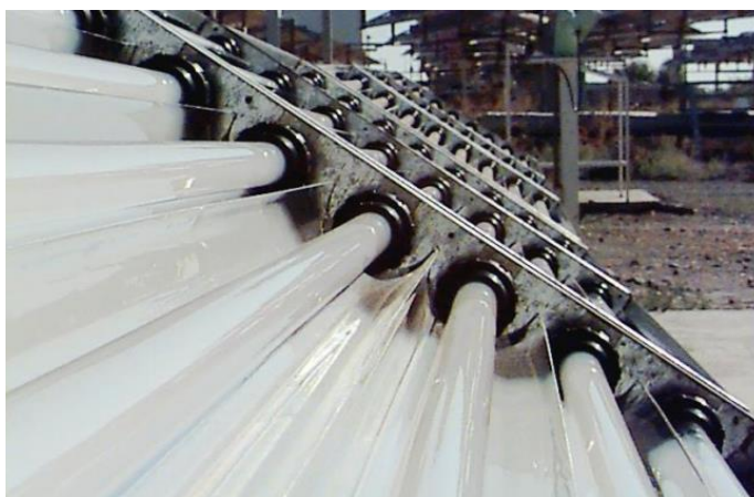
Figura 9. Foto reactor CPC no concentrado adaptado de Blanco Gálvez et al. (2004)
