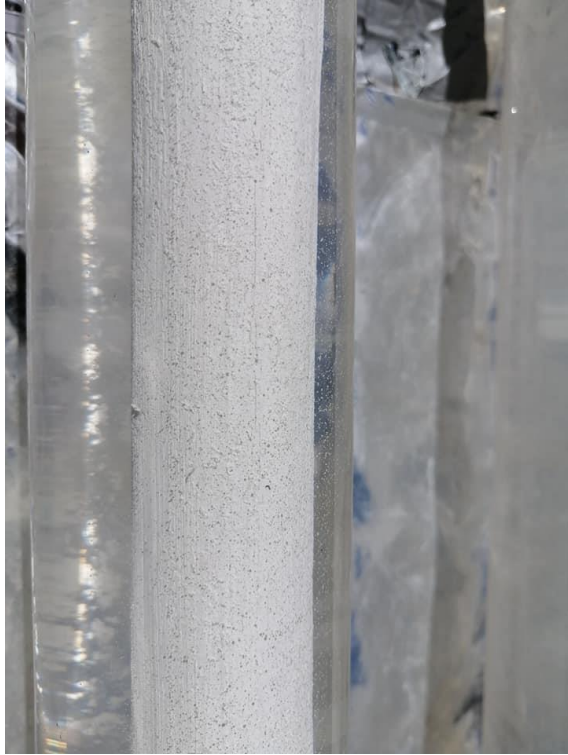
Figura 9. Varilla de madera encapsula con Pintura Epóxica y fijada con \text{TiO}_2 en contacto con el agua a tratar.
