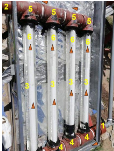
Figura 25. Circuito de tubería de vidrio Fotocatalítico con varillas de madera fijadas con el catalizador (TiO 2 ).
