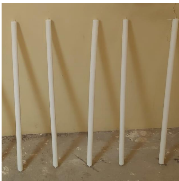
Figura 24. Tubos fijados con Dióxido de Titanio ( TiO_2 )
