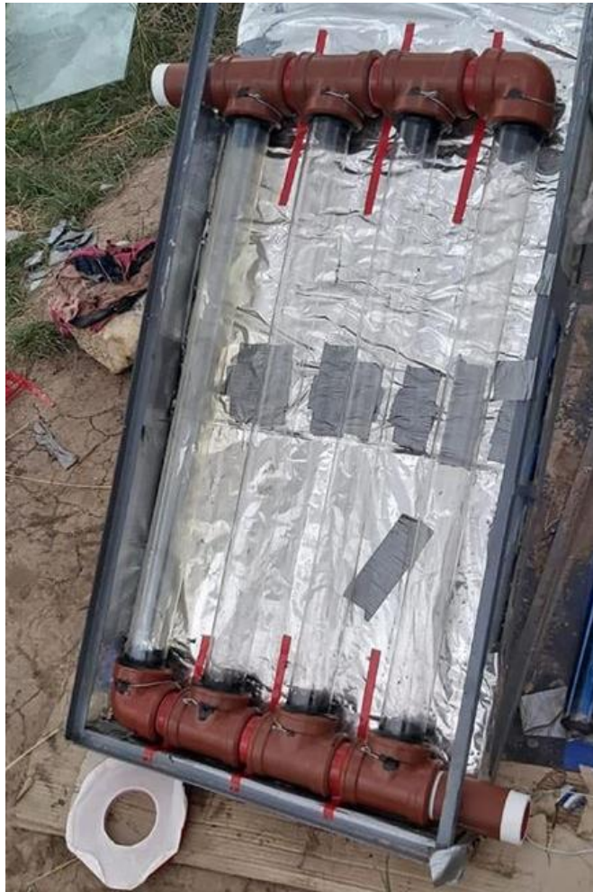
Figura 3. Diseño final del reactor sin varillas de dióxido de Titanio ( \text{TiO}_2 )
