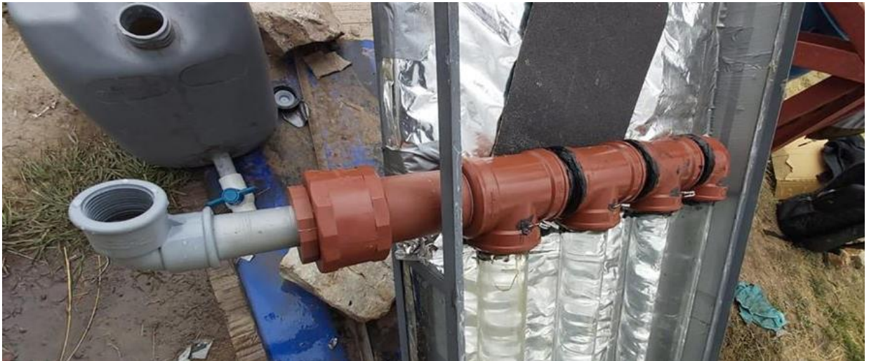
Figura 5. Unión de tubería Tipo IPS en sección parte superior para poder sujetar los tubos de vidrio tipo Pírex
