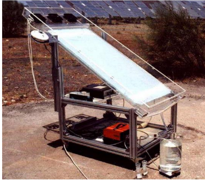
Figura 10. Reactor solar de tipo CPI adaptado de Blanco Gálvez et al. (2004)
