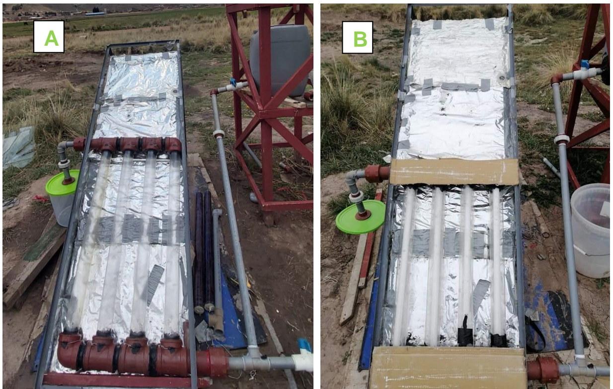
Figura 26. Reactor ensamblado A) sin catalizador y B) con catalizador.
