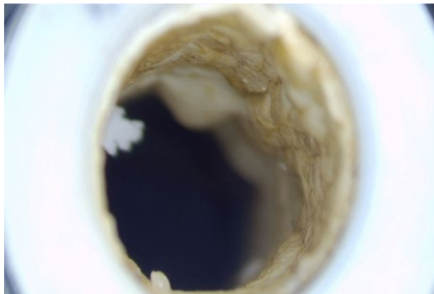
Figura 8. Filtro de nitrocelulosa posterior al tratamiento
