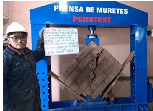
Figura 8. Ensayo de laboratorio para la compresión diagonal de muretes.
