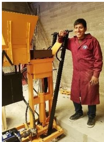
Figura 9. Vista del equipo hidráulico utilizado para la elaboración de bloques de suelo cemento
