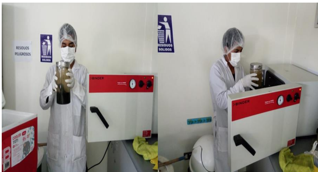
Figura 91. Incubación de los electrodos (ánodo) a 35°C
