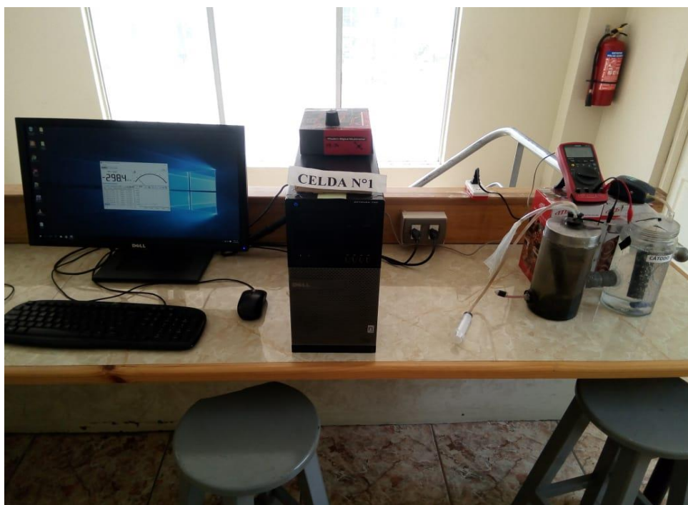
Figura 62. Monitoreo de las CCM y medición de voltaje con el Multímetro digital PRASEK PREMIUM PR-36
