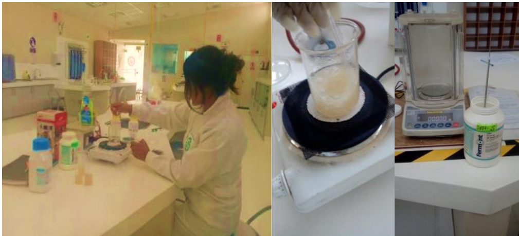
Figura 86. Preparación del Puente Salino
