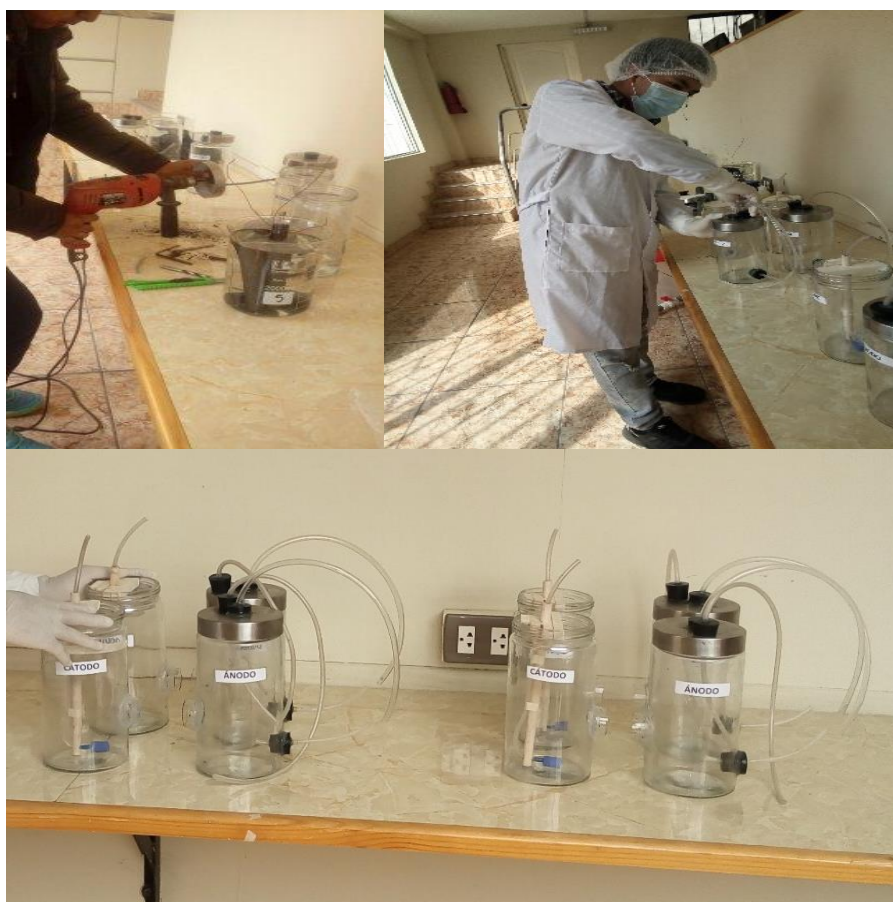
Figura 24. Construcción de las CCM a escala laboratorio
