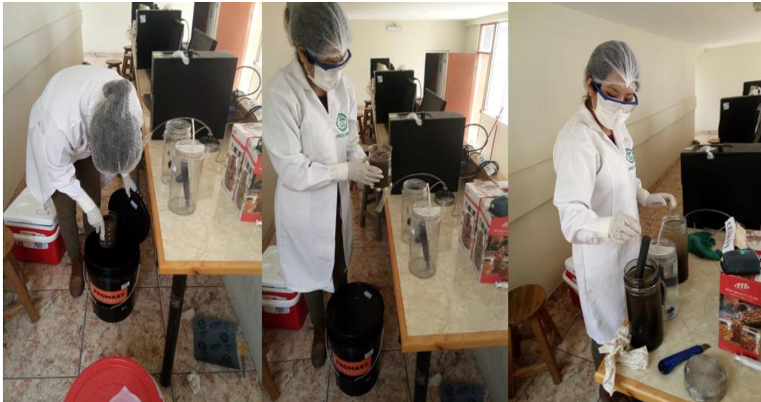
Figura 92. Inmersión de los electrodos en las CCM y cerrado hermético inmediatamente
