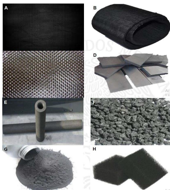
Figura 14. Principales materiales utilizados como electrodos en las CCM: (A) tela de carbón; (B) fieltro de grafito; (C) fibra de carbón; (D) placa de grafito; (E) barra de grafito; (F) grafito granular o carbón activado granular; (G) carbón activado en polvo.
