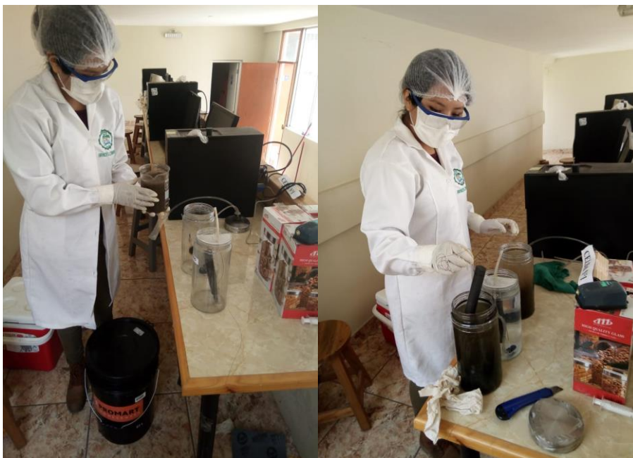
Figura 42. Acondicionamiento de la CCM para la fase de aclimatación
