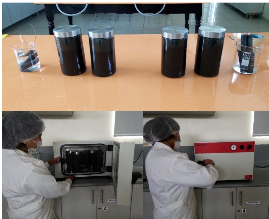
Figura 41. Acondicionamiento de los electrodos para la formación de la biopelícula de microorganismos electrogénicos
