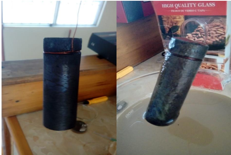
Figura 93. Electrodo de la derecha sin formación de la biopelícula de microorganismos y electrodo de la derecha con formación de biopelícula de Microorganismos.
