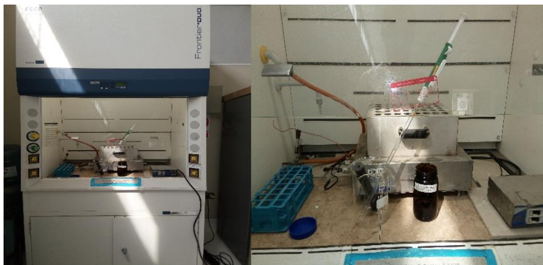
Figura 88. Campana extractora de gases
