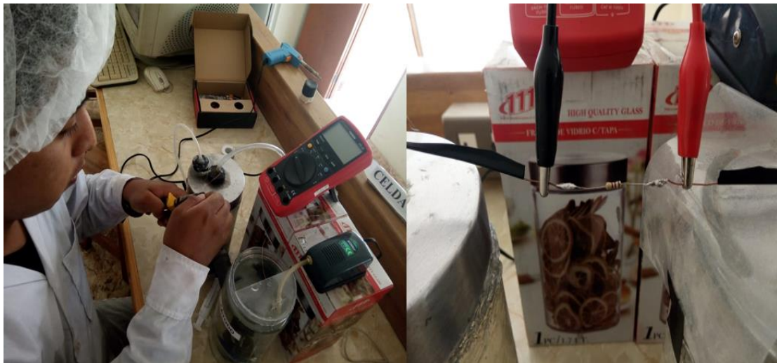
Figura 94. Soldadura de las resistencias externa (150,100,50 \Omega ) con estaño
