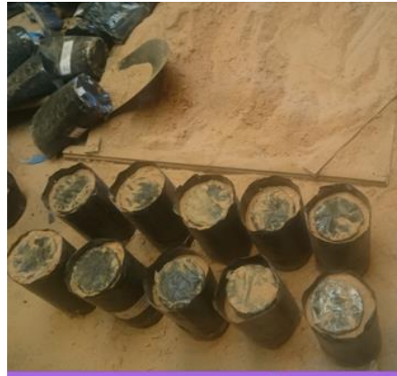
Figura 3.19. Protección con Polietileno y Aserrín
