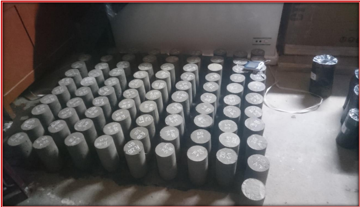
Fotografía N° 14: Identificación de los especímenes de concreto.
