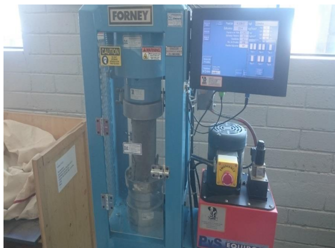
Figura 3.9. Máquina de compresión digital de la UPeU Juliaca.
