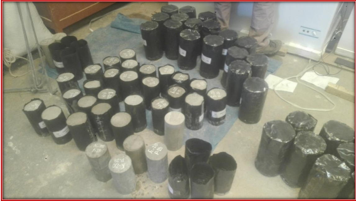
Fotografía N°21: Protección del concreto con Polietileno (Plástico)
