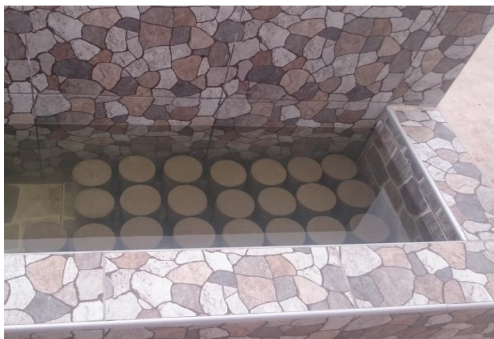
Figura 3.16. Curado sumergido de especímenes en pozas
