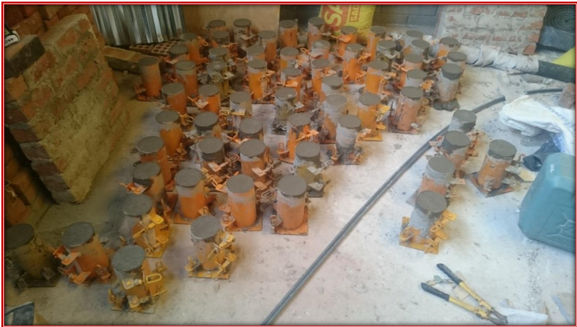
Fotografía N°12: Acabado Superior de las probetas de concreto.
