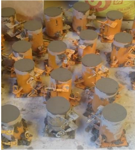
Figura 3.14. Acabado de las probetas de concreto Figura 3.15. Identificación de las probetas
