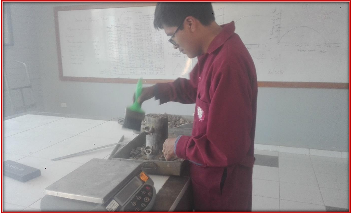
Fotografía N°07: Peso Unitario del Agregado Grueso
