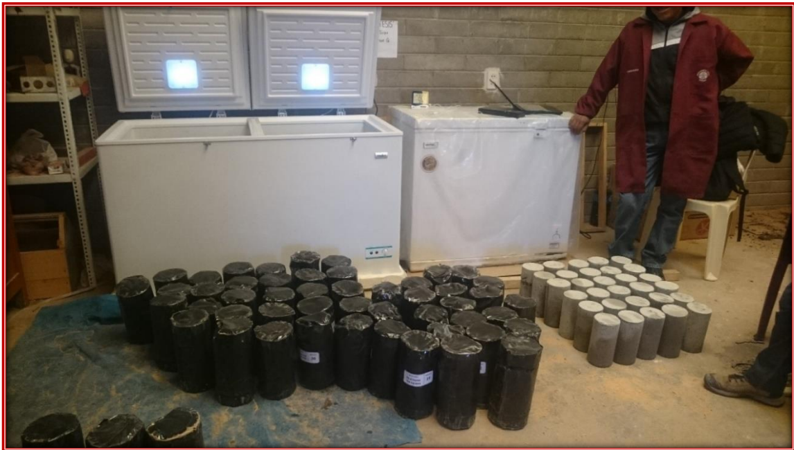
Fotografía N°22: probetas de concreto sin protección
