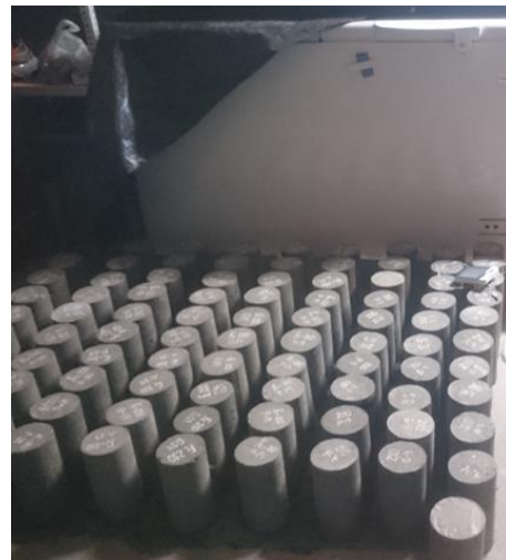
Figura 3.14. Acabado de las probetas de concreto Figura 3.15. Identificación de las probetas
