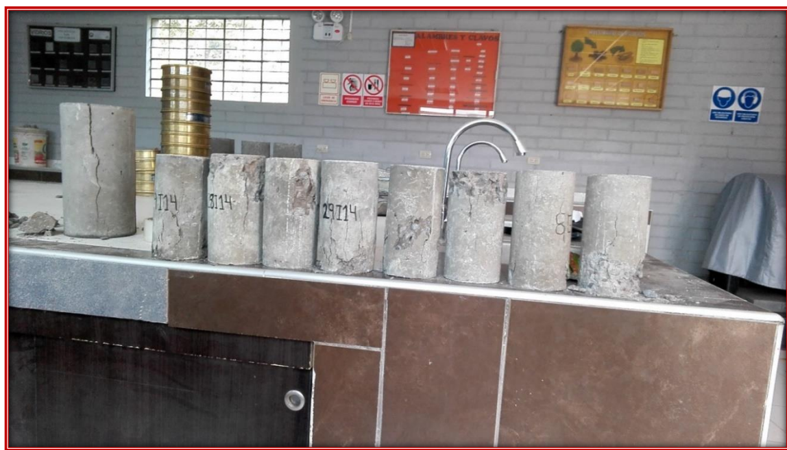
Fotografía N°28: Probetas de concreto ya ensayadas a compresión
