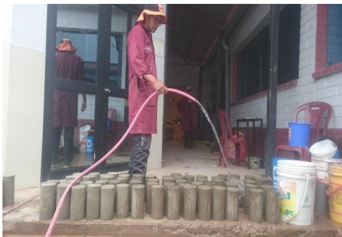
Figura 3.17. Curado del concreto método riego.
