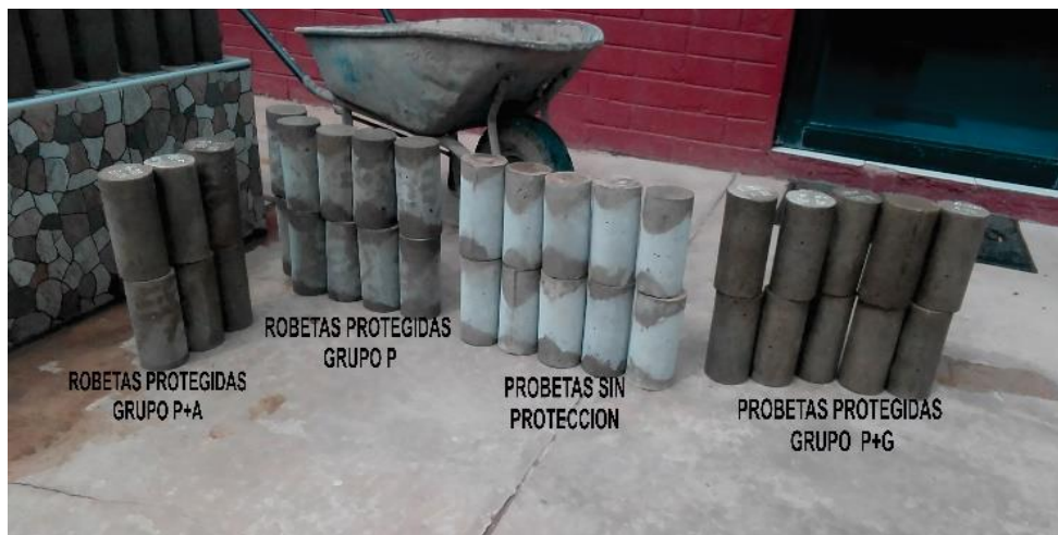
Figura 3.26. Efecto superficial de las bajas temperatura en los especímenes
