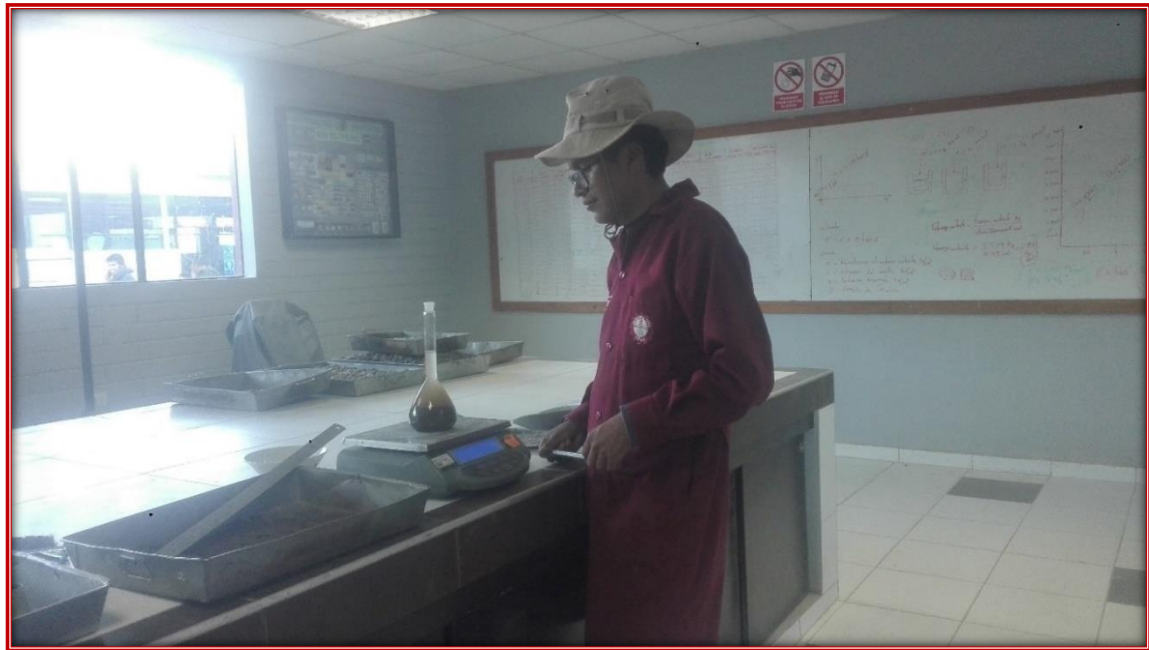
Fotografía N°05: Peso Específico del agregado Fino
