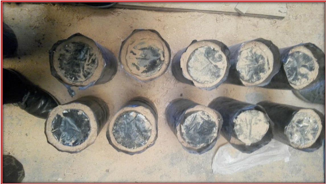
Fotografía N°20: Protección de las probetas con polietileno y Aserrín
