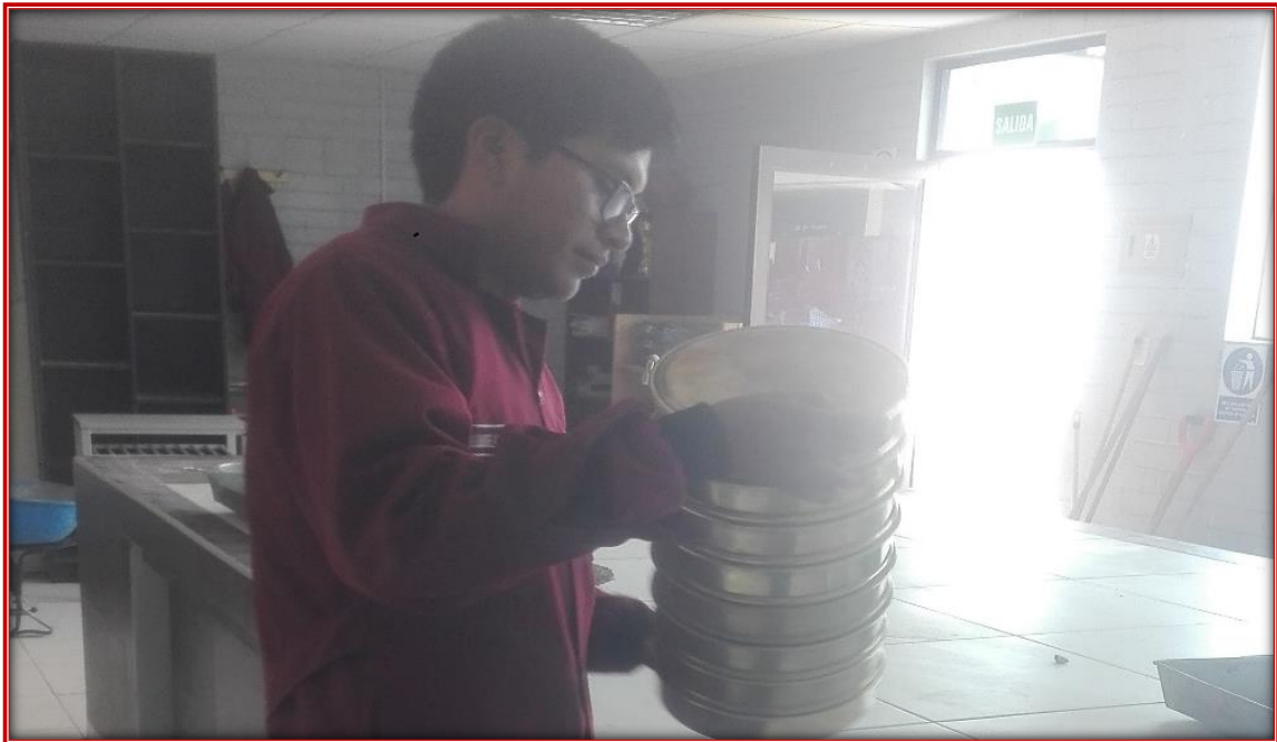
Fotografía N°03: Tamizado del Agregado
