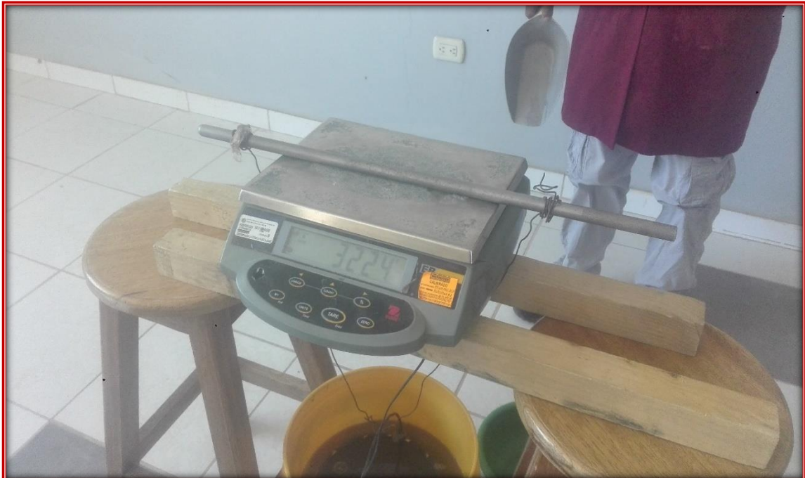
Fotografía N°04: Ensayo de Peso Específico del Agregado Grueso
