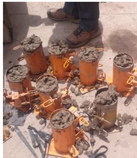
Figura 3.13. Llenado de los moldes con concreto
