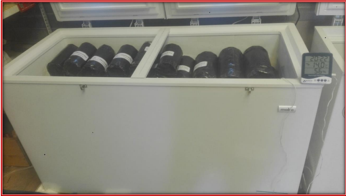
Fotografía N°23: Colocación de Probetas en la congeladora
