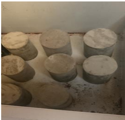
Figura 3.20. Concretos sin protección
