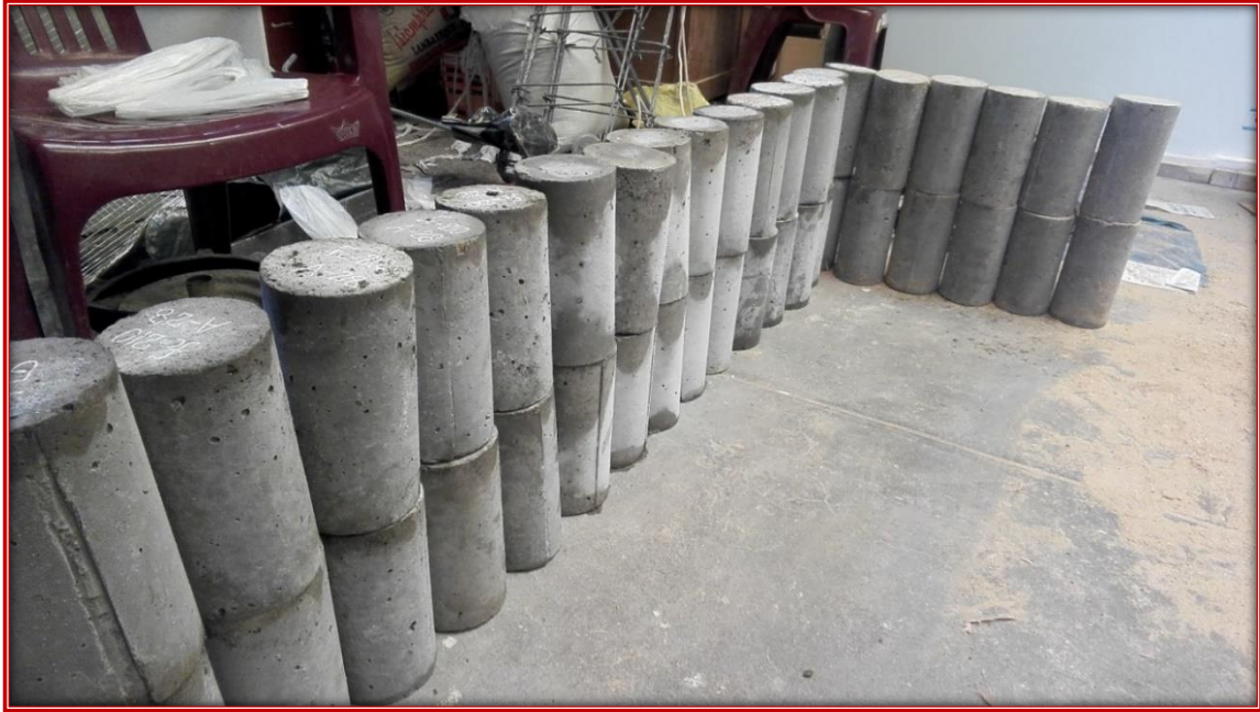
Fotografía N°25: Probetas después del ciclo de congelamiento
