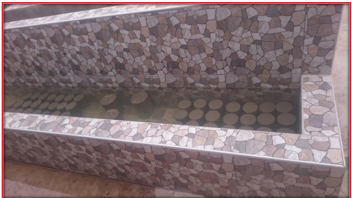
Fotografía N°16: Curado de Probetas Sumergidas a la intemperie.
