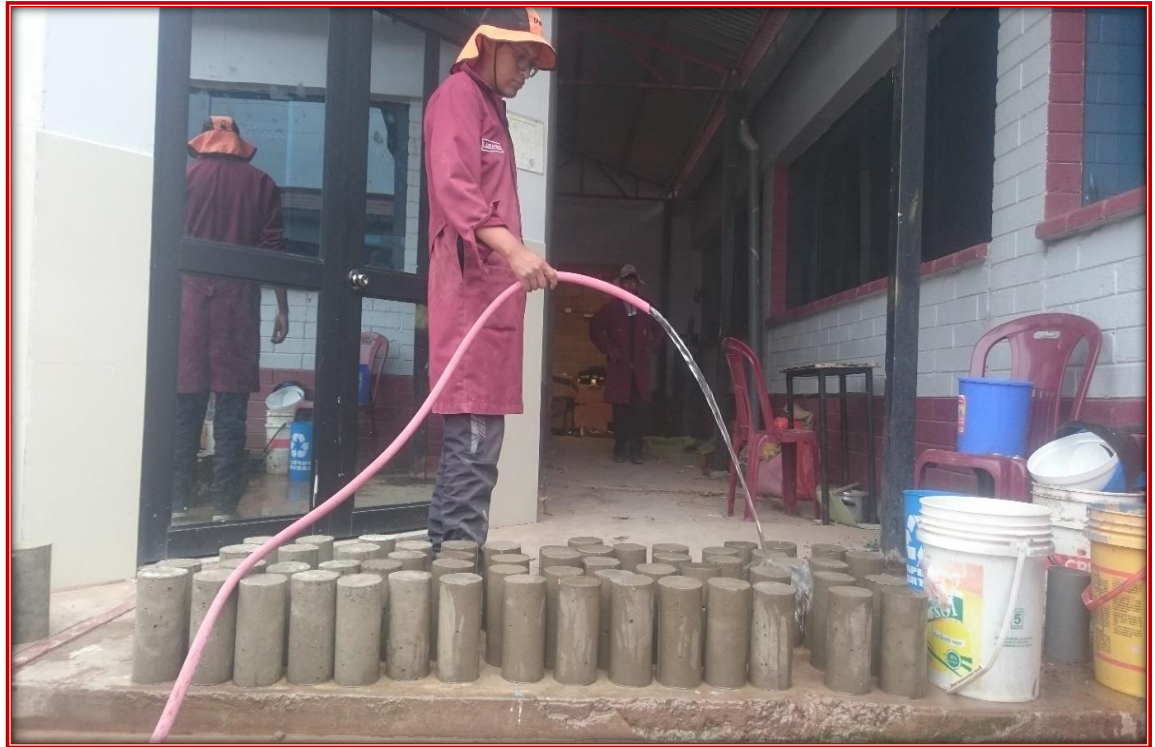
Fotografía N°15: Curado por Riego de las probetas.
