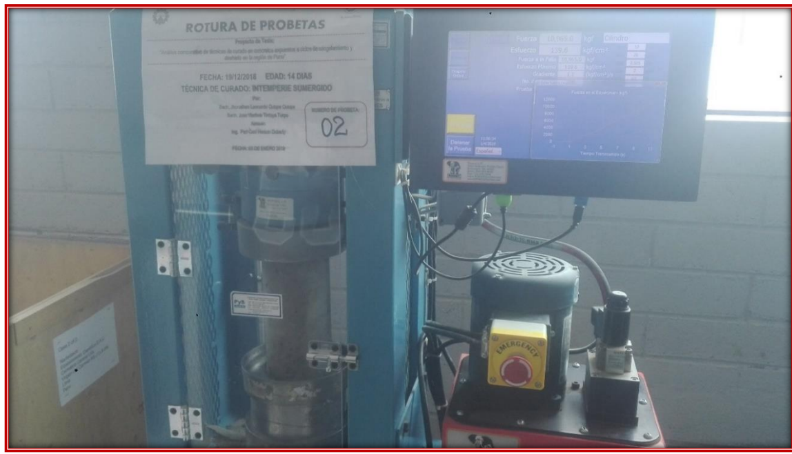
Fotografía N°27: Rotura de probetas de concreto
