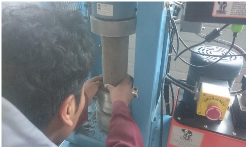
Figura 3.28. Colocado de los especímenes de concreto a la máquina compresora.
