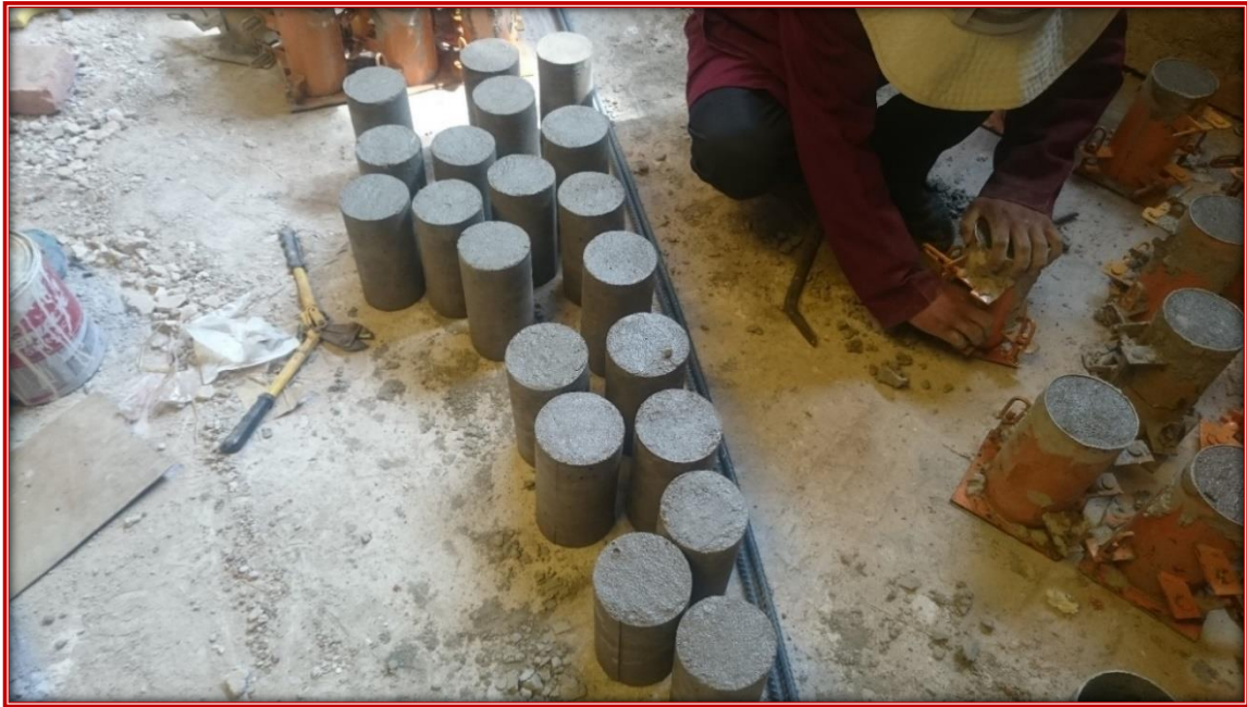
Fotografía N°13: Desmolde de las probetas de concreto
