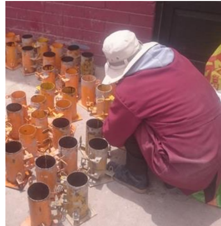
Figura 3.11. Colocación del desmoldante.
