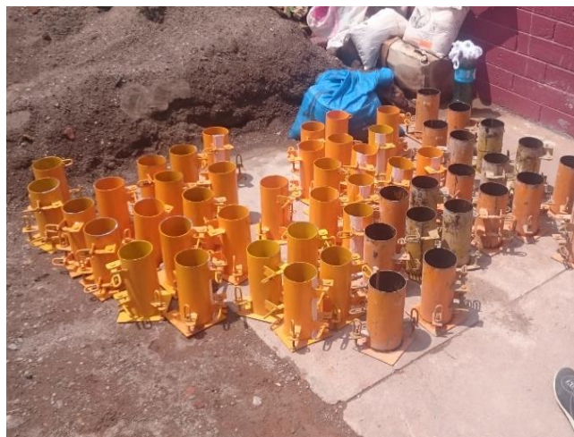
Figura 3.8. Moldes cilíndricos 4" X 8"
