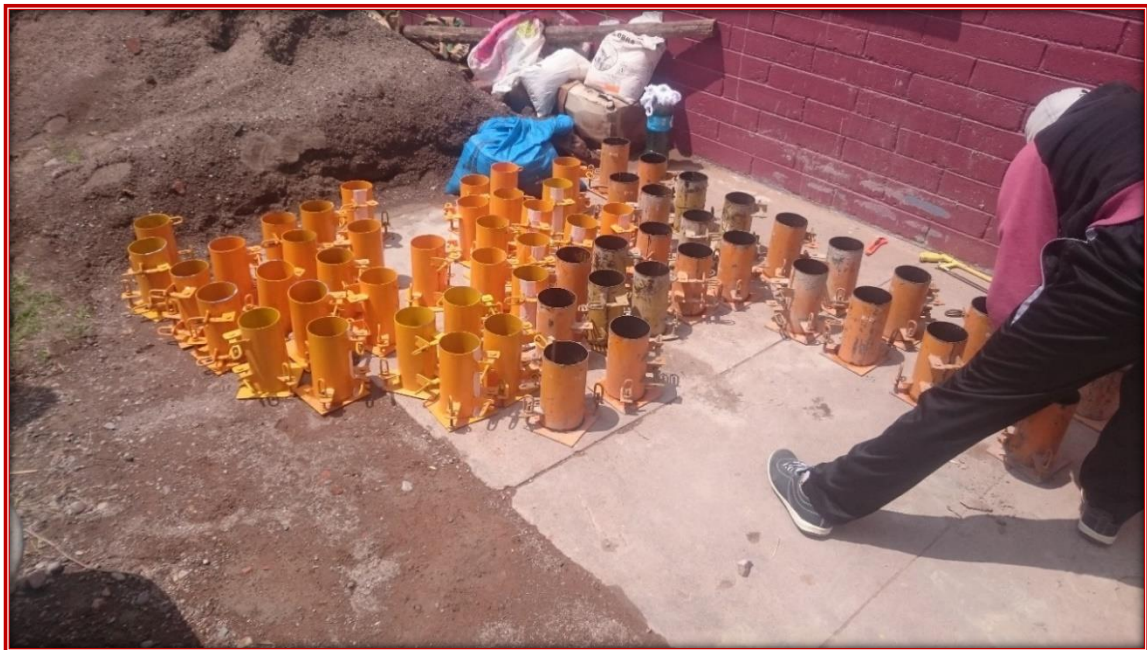
Fotografía N°10: Moldes cubiertos con petróleo.
