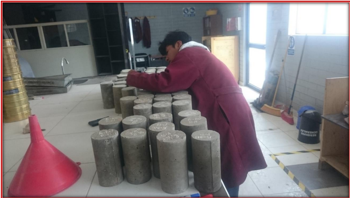
Fotografía N°26: Medida de las alturas de los especímenes de concreto.
