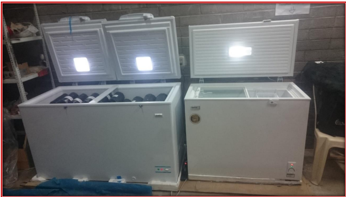
Fotografía N°24: Probetas de concreto en las congeladoras para el ciclo de congelamiento
