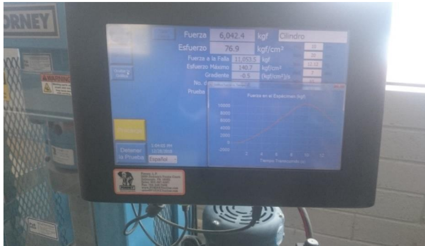
Figura 3.29. Registro del ensayo a compresión del concreto.
