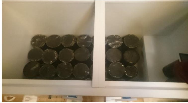
Figura 3.22. Colocado de las probetas con protecciones a la congeladora.
