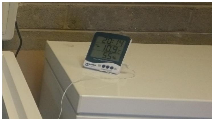
Figura 3.24. Termohigrómetro para registrar las temperaturas
