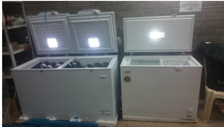
Figura 3.23. Probetas con protecciones colocadas en las congeladoras.
