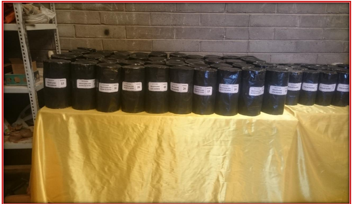
Fotografía N°18: Moldes de plásticos para la protección de las probetas.
