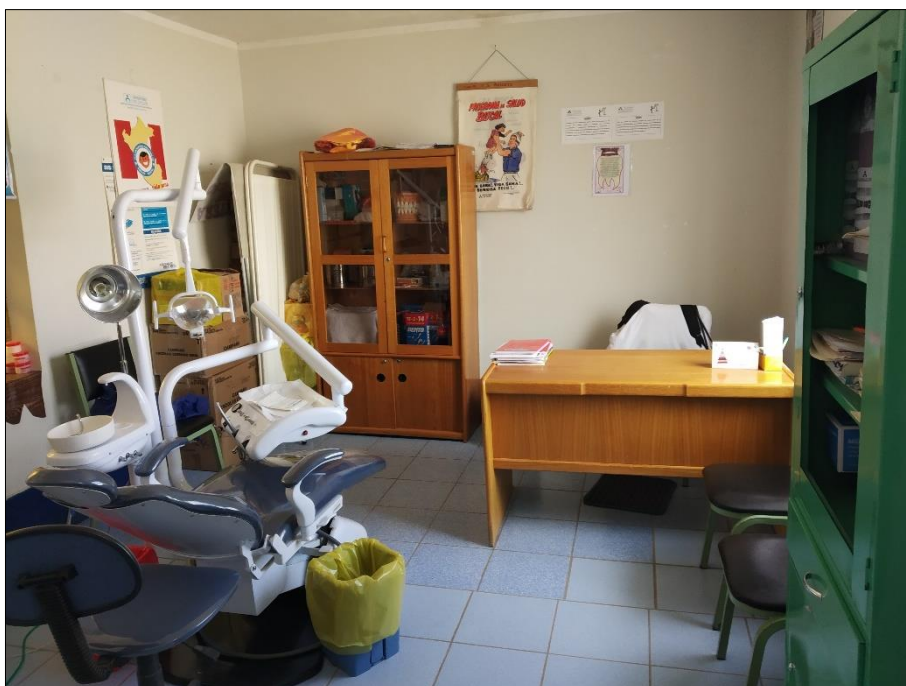
Figura 50. Equipos médicos desprotegidos y sin anclaje - Odontología. (Elaboración propia).
