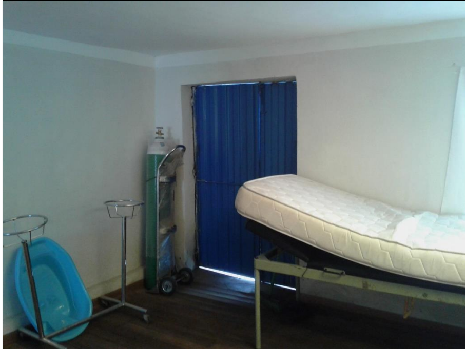
Figura 39. Balón de oxígeno sin sujeción - internamiento. (Elaboración propia).
