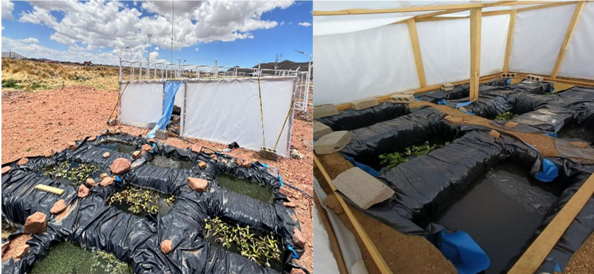
Figura 1. Montaje del sistema experimental de tratamiento de aguas residuales mediante macrófitas acuáticas y protección térmica pasiva.
