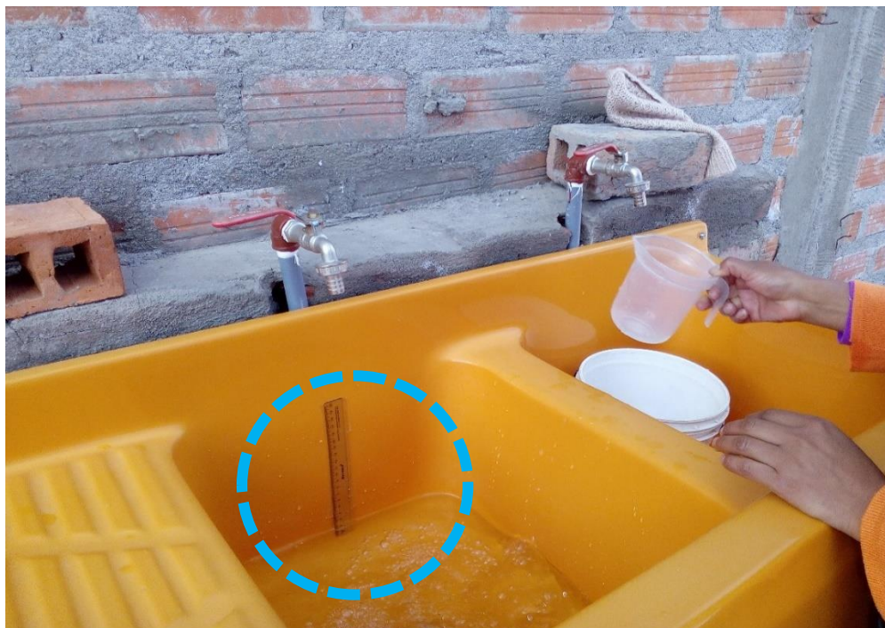
Figura 6. Escala de medición para correspondencia con volumen de producción de agua gris en lavatorio de ropa.
