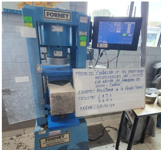
Figura 5. Prueba de resistencia a la flexión (NTP 339.079)
