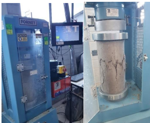
Figura 4. Máquina de ensayo a compresión (NTP 339.034)
