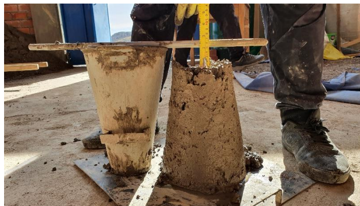
Figura 6. Prueba de Slump con el cono de Abrams (NTP 339.035)
