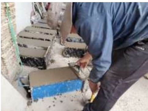
Fig. 8. Preparación de muestras (probetas)
