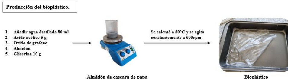
Figura 2. Diagrama de la fabricación de bioplásticos a partir de almidón de cáscara de papa y óxido de grafeno.
