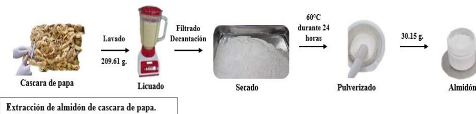
Figura 1. Diagrama del proceso de extracción de almidón.
