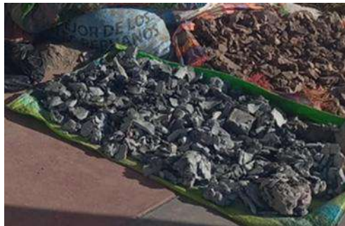
Figura 10. Preparación de muestra de suelo de las calicatas
