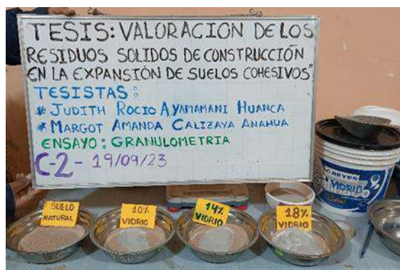
Figura 12. Preparación de muestra + tratamiento para ensayo de CBR
