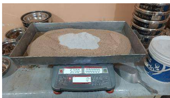
Figura 12. Preparación de muestra + tratamiento para ensayo de CBR
