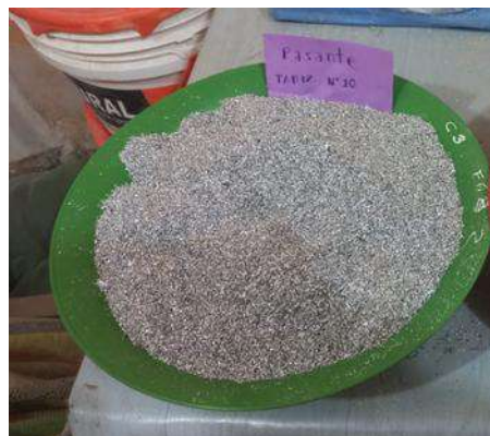
Figura 8. Preparación de material viruta de aluminio
