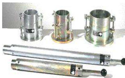
Figura 4. Equipo de compactación Proctor modificado
