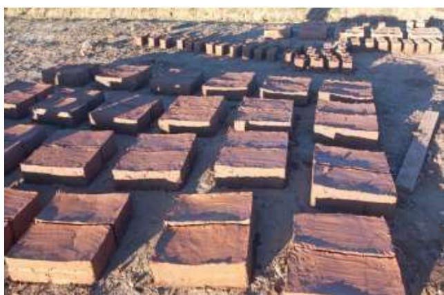
Figura 16 secado de muestras de adobe convencional y mejorado
