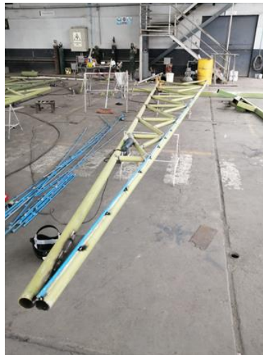
Figura N°62: Armado de tijera 3. Fuente: Elaboración Propia.
