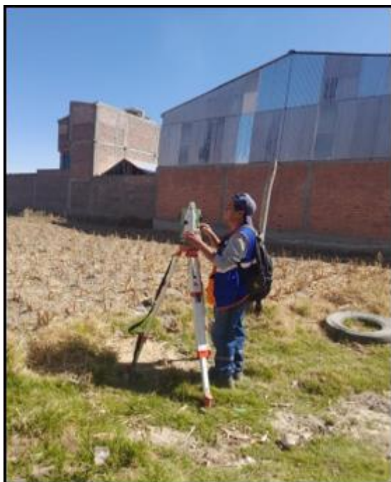
Figura N°19. Levantamiento topográfico Pasaje 03. Fuente: IOARR del proyecto 02.
