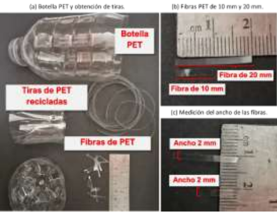
Figura 1. Obtención y caracterización dimensional de las fibras PET recicladas empleadas como refuerzo del mortero: (a) obtención de tiras a partir de botellas PET; (b) fibras de 10 mm y 20 mm de longitud; (c) medición del ancho promedio de 2 mm.
