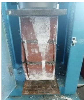
Figura 3: Ensayos de control en prismas de albañilería, dados de concreto y unidades de ladrillo.
