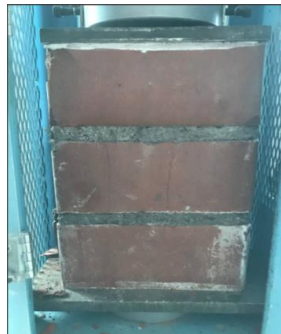
Figura 3: Ensayos de control en prismas de albañilería, dados de concreto y unidades de ladrillo.
