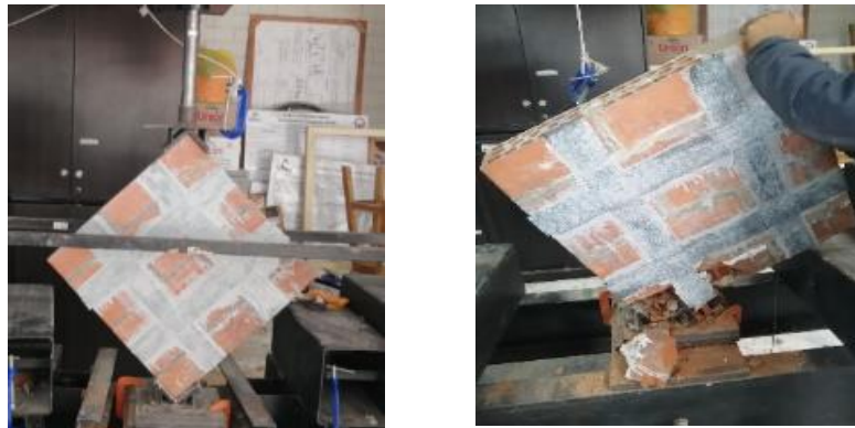
Figura 6: Ensayo de compresión diagonal muretes reforzados con la configuración C2.
