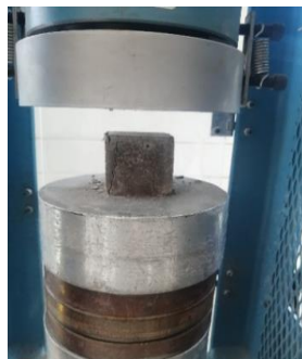
Figura 3: Ensayos de control en prismas de albañilería, dados de concreto y unidades de ladrillo.
