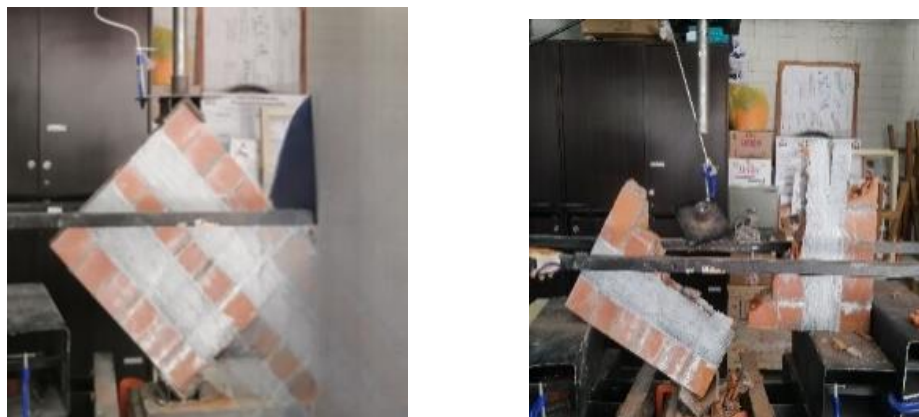
Figura 7: Ensayo de compresión diagonal muretes reforzados con la configuración C3.
