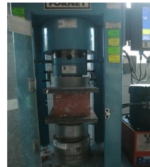
Figura 3: Ensayos de control en prismas de albañilería, dados de concreto y unidades de ladrillo.
