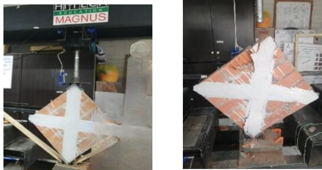
Figura 5: Ensayo de compresión diagonal muretes reforzados con la configuración C1.
