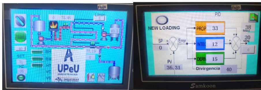
Imagen 2. Interfaces de referencia de control PLC.
