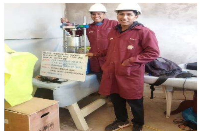
Figura 6: Realización de los ensayos de CBR.
