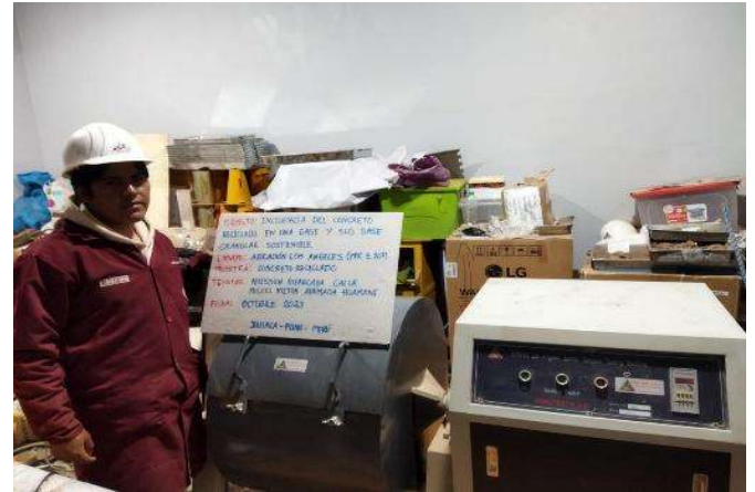
Figura 4: Realización del ensayo de abrasión los ángeles.
