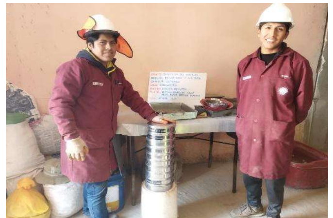
Figura 5: Realización de los ensayos granulométricos.
