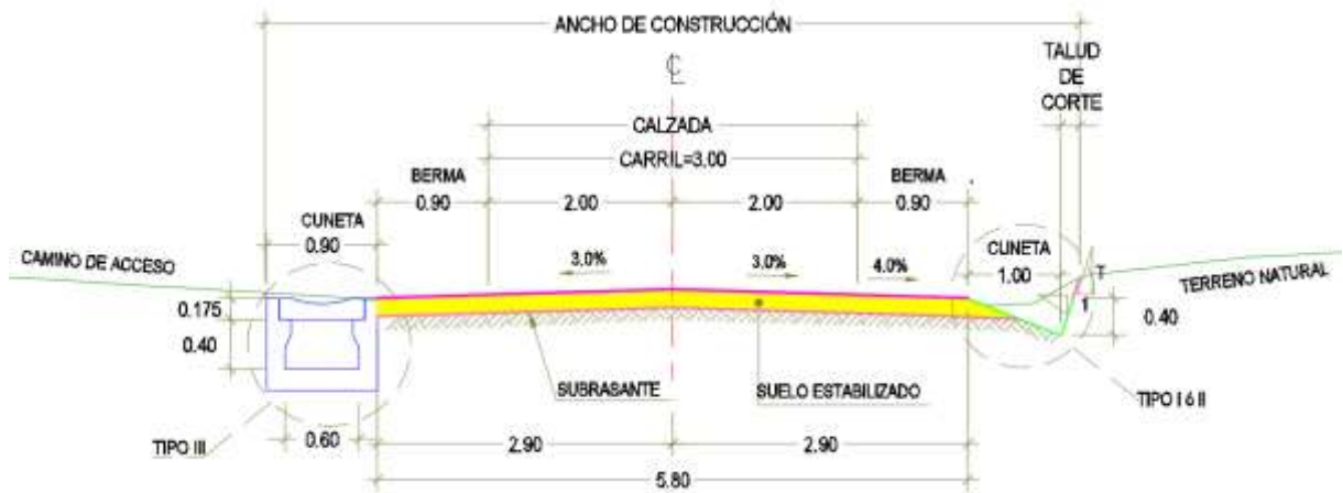
Figura N° 40 Sección típica en corte cerrado con cuneta rectangular. Fuente: Plano de secciones típicas.
