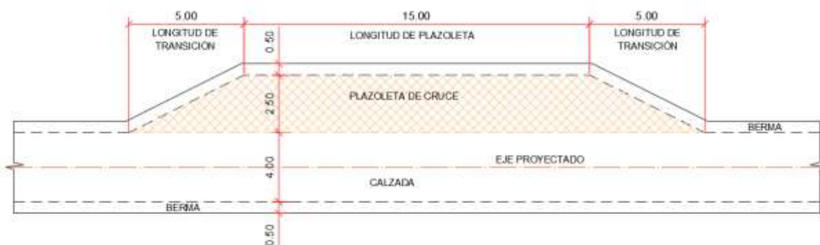
Figura N° 47 Detalle típico de plazoleta de cruce. Fuente: Plano de detalles de Plazoletas A continuación, se presenta la relación de plazoletas consideradas en el proyecto.
