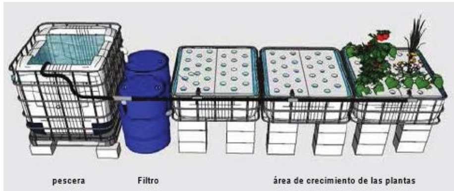
Figura 14. Raíz flotante o cultivo de agua profunda (Somerville et al. , 2014)
