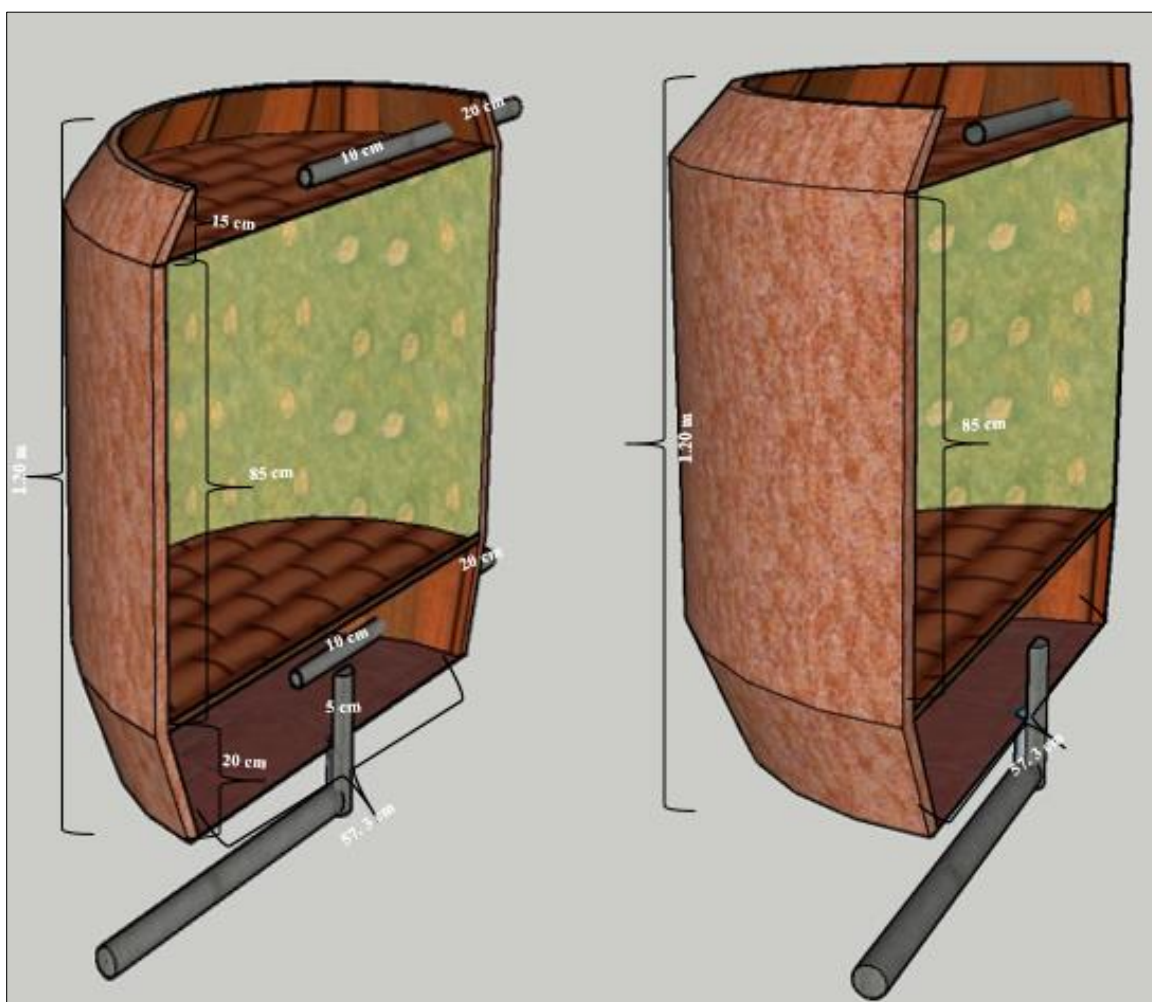
Figura 8. Dimensiones del filtro anaerobio
