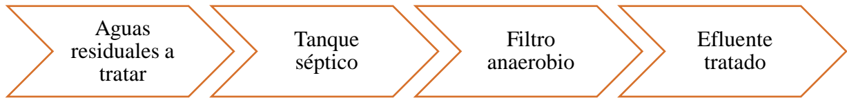
Figura 5. Diagrama de flujo del sistema del agua residual
