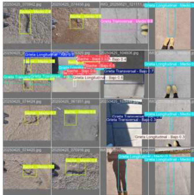
Figura 8 Resultados de imágenes procesadas correspondientes al conjunto de prueba, en las que se aplicó el modelo YOLOv11l.
