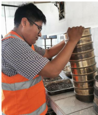
Figura 1. Ejecución de ensayo granulométrico
