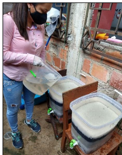
Figura 6 Proceso de filtrado del agua del manantial Rumisillo
