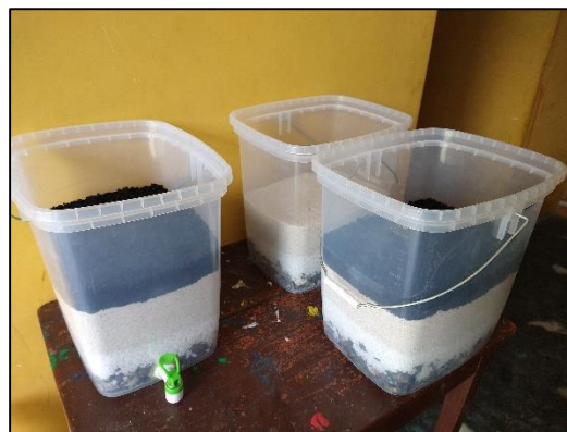
Figura 4 Proceso de fabricación de los filtros.
