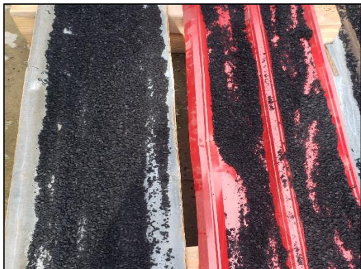
Figura 3 Carbón activo granular de Attalea phalerata y Mauritia flexuosa .
