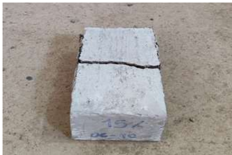
Figura 7. Rotura de adoquín vista superior
