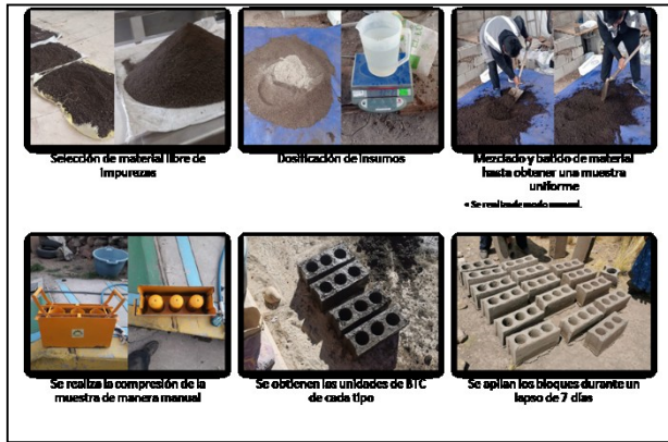
Fig. 3. Proceso de fabricación de BTC, BTC con adiciones de 7%, 9% y 11%
