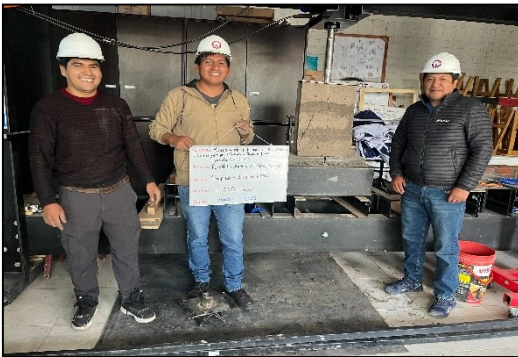
Fig. 12. Prueba de resistencia a la compresión diagonal de muretes de albañilería
