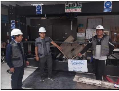
Fig. 11. Prueba de resistencia a la compresión diagonal de muretes de albañilería
