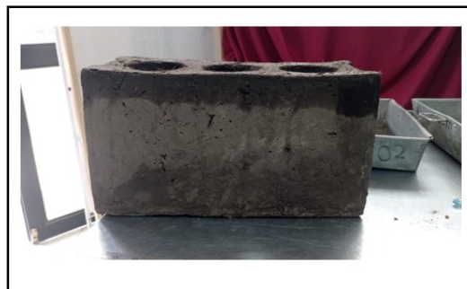
Fig. 10. Ensayo de capilaridad de BTC. Fuente Elaboración Propia
