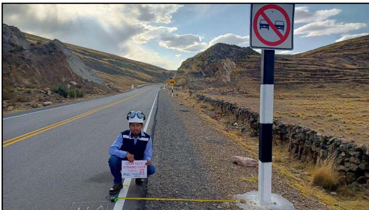
FOTOGRAFIA N° 12: EN LA IMAGEN SE MUESTRA LA DISTANCIA MINIMA DE LA UBICACION LATERAL DE LA SEÑALIZACION DE PROHIBICION EN LA PROGRESIVA 18+560. SEGÚN EL MANUAL DE DISPOSITIVOS DE CONTROL DE TRANSITO AUTOMOTOR PARA CALLES Y CARRETERAS
