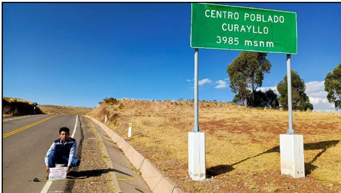
FOTOGRAFIA N° 02: EN LA IMAGEN SE MUESTRA EL INICIO DE TRAMO PROGRESIVA 17+100, DONDE SE ESTA COMPROBANDO LA DISTANCIA MINIMA DE LA UBICACION LATERAL DE LA SEÑALIZACION
