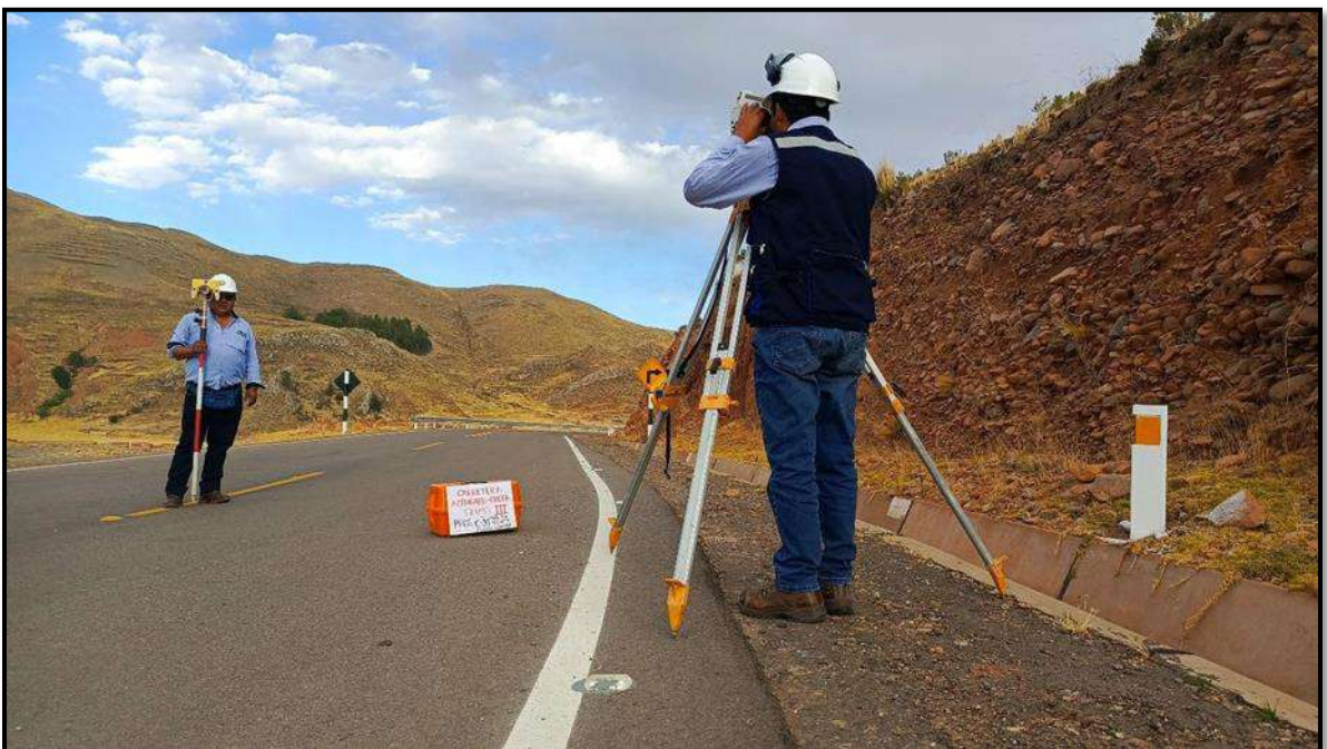
FOTOGRAFIA N° 16: EN LA IMAGEN SE MUESTRA LA OBTENCION DE LAS LONGITUDES DE TANGENTES MINIMAS ADMISIBLES Y MAXIMAS DESEABLES EN LOS TRAMOS EN TANGENTE CON EL EQUIPO TOPOGRAFICO ESTACION TOTAL.
