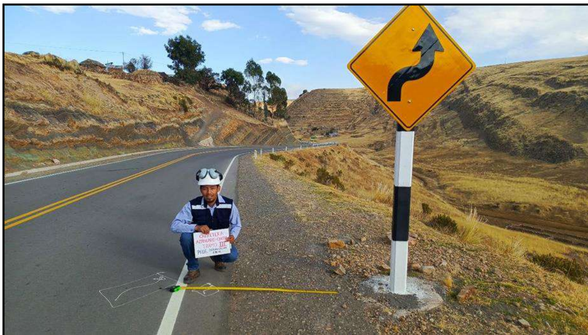
FOTOGRAFIA N° 11: EN LA IMAGEN SE MUESTRA LA DISTANCIA MINIMA DE LA UBICACION LATERAL DE LA SEÑALIZACION DE PREVENCION EN LA PROGRESIVA 19+020. SEGÚN EL MANUAL DE DISPOSITIVOS DE CONTROL DE TRANSITO AUTOMOTOR PARA CALLES Y CARRETERAS
