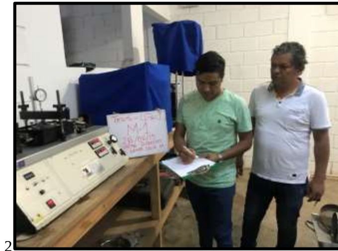
Figura N° 3-8 Ensayo de corte directo
