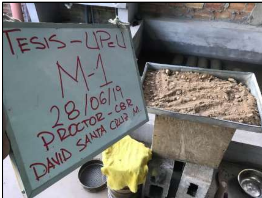
Muestra destinada al ensayo del CBR
