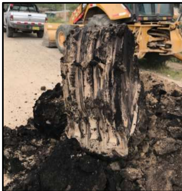
Muestreo en calicata C-8 Presencia de material arcilloso oscuro (Fecha de exploración 27/06/2019)
