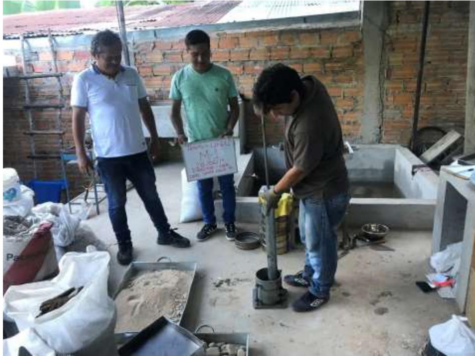
Realización del ensayo de Proctor a la Muestra 01 (Fecha de ensayo 28/06/2019)
