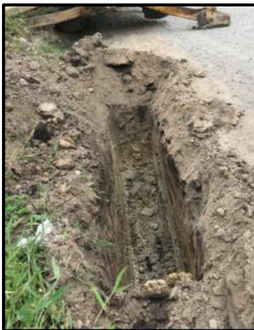
Apertura de calicata C-5 – Presencia de arcilla gris oscuro (Fecha de exploración 27/06/2019)
