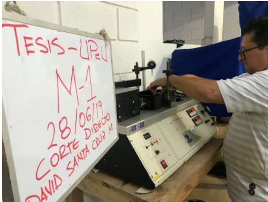
Realización del ensayo de Corte directo (fecha de ensayo 28/06/2019)
