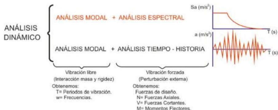
Figura 2-23. Esquema Conceptual de del Análisis Dinámico (Cutimbo, 2016)
