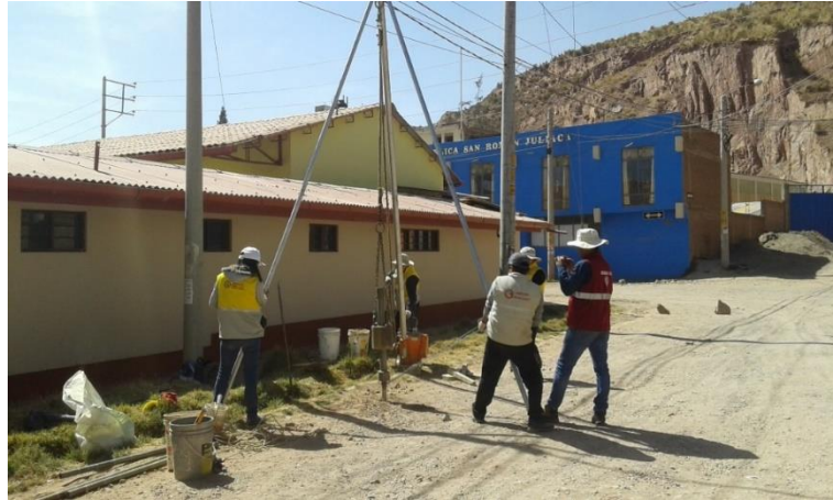
Figura 3-8. Ensayo de Penetración Estándar (SPT) en campo.
